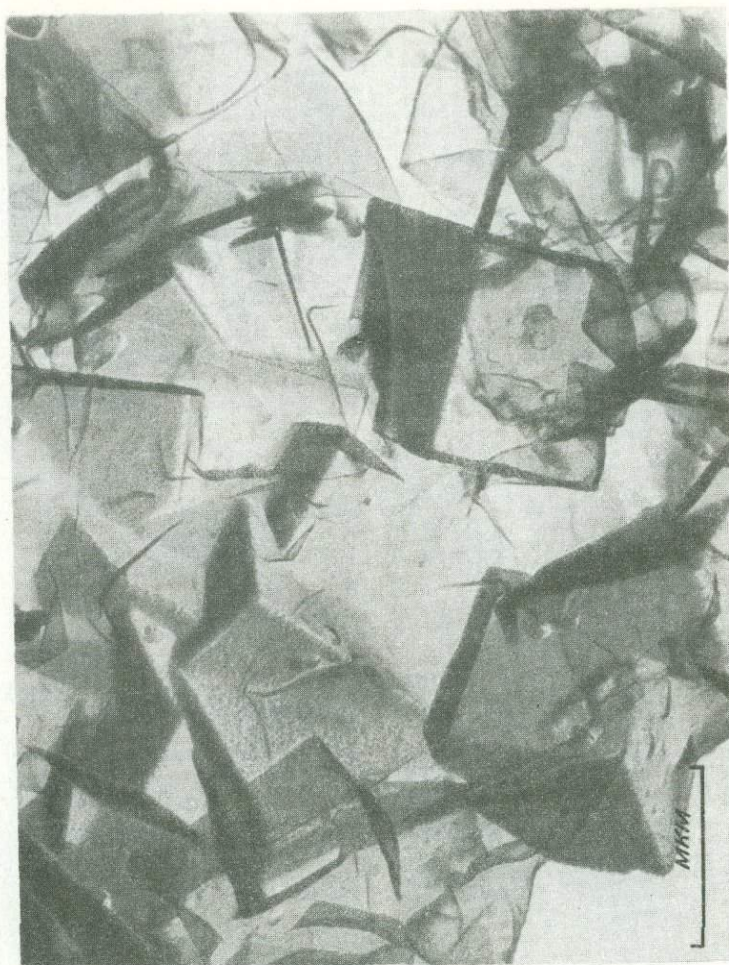
Фиг. 5. Ярозит, синтезированный при участии микроорганизма Thiobacillus ferroxidans . Угольная реплика
