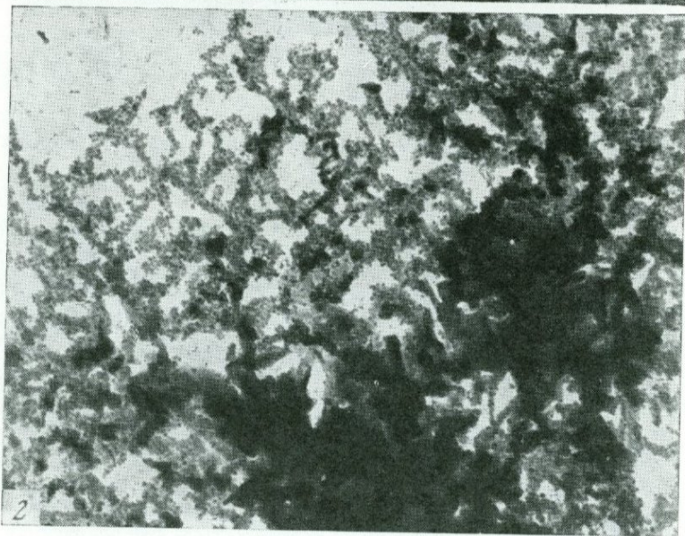
1 — пористая корочка тонкокристаллического реальгара. Отраженный свет. Увел. 90; 2 — губчатые агрегаты глобуль коллоидного сульфида мышьяка ( As_2S_3 ) — метареальгара. Темные окристаллизованные частицы — реальгар. Угольная реплика. Увел. 20 000
