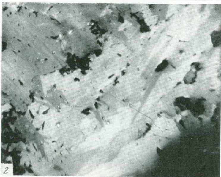
1 — прожилок переотложенного алунита с энергитом в опалитах, глубина 179 м, скв. 33. Natur. вел.; 2 — кристаллы энергита. Увел. 20
