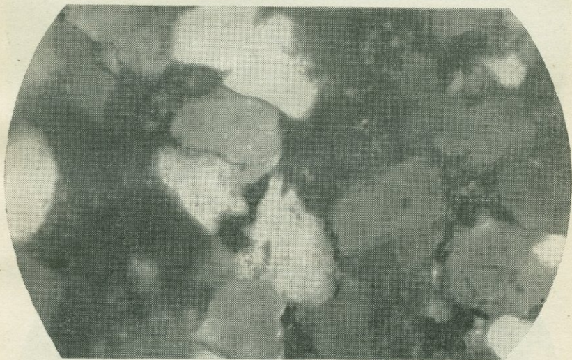
Рис. 37. Каолинитовый цемент базального типа. Алакаевская, скв. 9, обр. 36, ув. 200, ник. \times .
