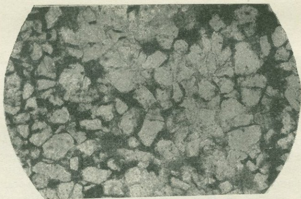
Рис. 34. Гидрослюда разной степени гидратации. Чекмагуш, скв. 51, обр. 659.
