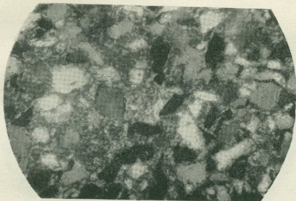
Рис. 30. Гидрослюда по полевому шпату. Куседа, скв. 23, обр. 225.
