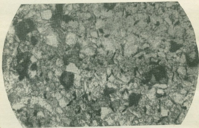
Рис. 36. Стяжения сидерита с зернами кварца в центре. Ефремово-Зыково, скв. 14, обр. 19, ув. 120, ник. ||.
