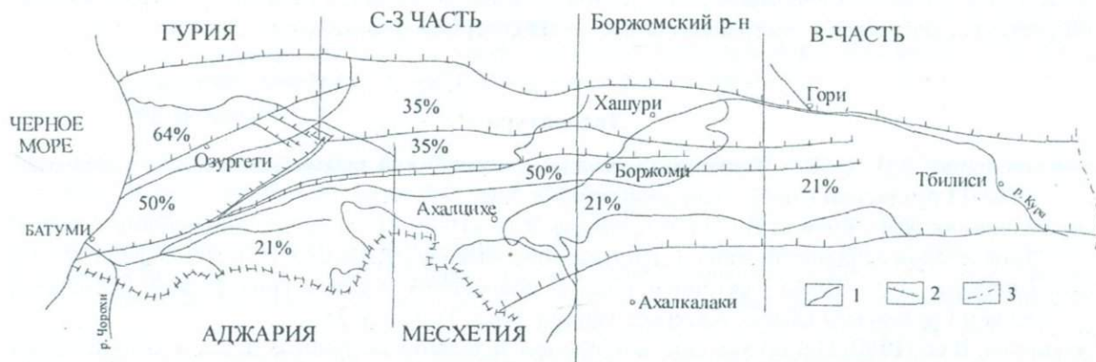
Рис. 2. Картирование вулканогенных пород Аджара-Триалети согласно данным калий-натриевого соотношения. Условн. обознач.: 1 - граница между зонами; 2 - тектонические нарушения; 3 - ось антиклинали
