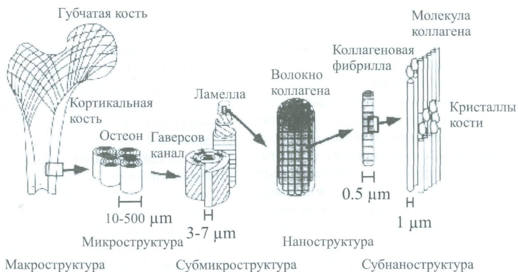
Рис.1.1. Неорганическая составляющая (биоапатит) в структуре многоуровневой модели организации костной ткани (Weiner, Wagner, 1998).
