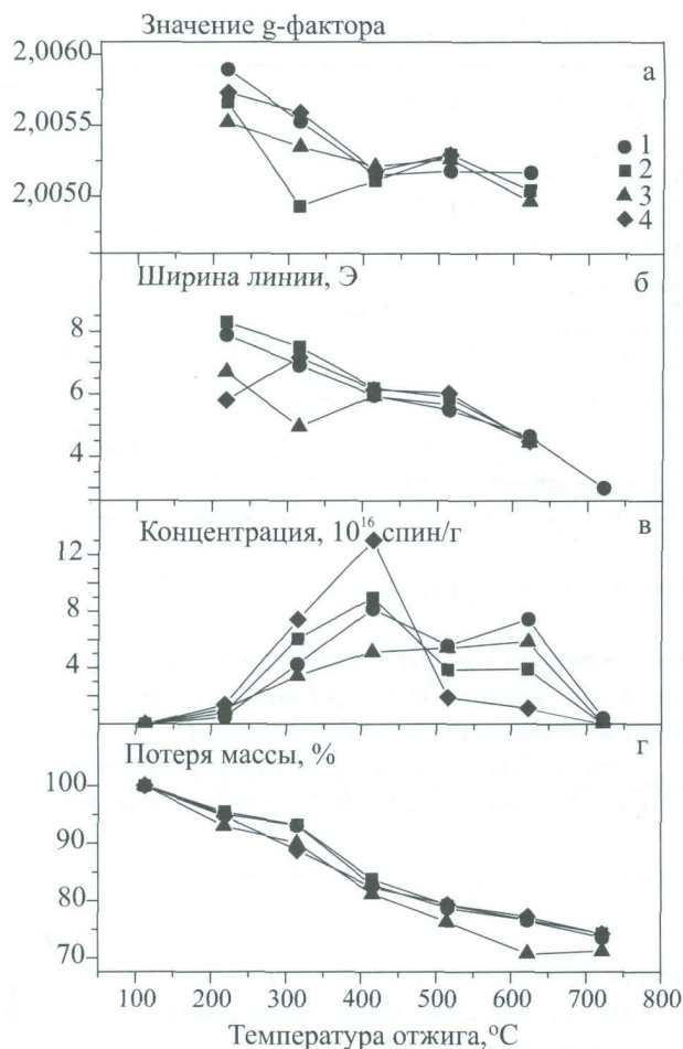
Рис. 2.9. Типичные зависимости значений g -фактора (а), ширины линии ЭПР (б), абсолютной концентрации ион-радикалов R_{\text{тх}} (в) и относительной массы M/M_0 (г) образцов диастем из местонахождений различного возраста от температуры их лабораторного отжига. Кривые 1, 3 – Arvicola terrestris , Навес Старик, гор. 1, н.ч. 1 и гор. 11, н.ч. 2; 2 – Arvicola terrestris , Грот Филин, н.ч. 3; 4 – Dicrostonyx torquatus , Дыроватый Камень, р. Чусовая, н.ч. 2. M_0 – исходная масса проб.
