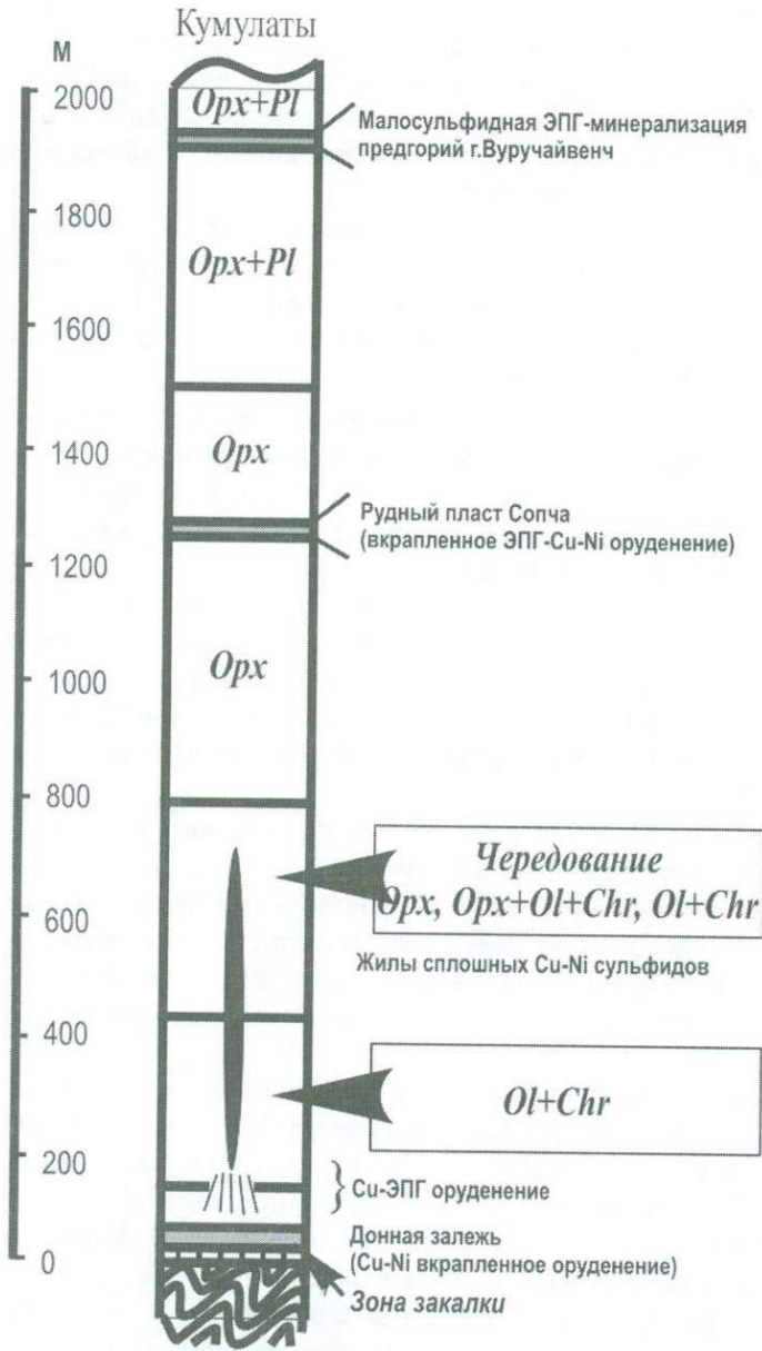
Рис. 2.12. Распределение сульфидной Cu-Ni-ЭПГ минерализации в разрезе Мончегорского плутона
