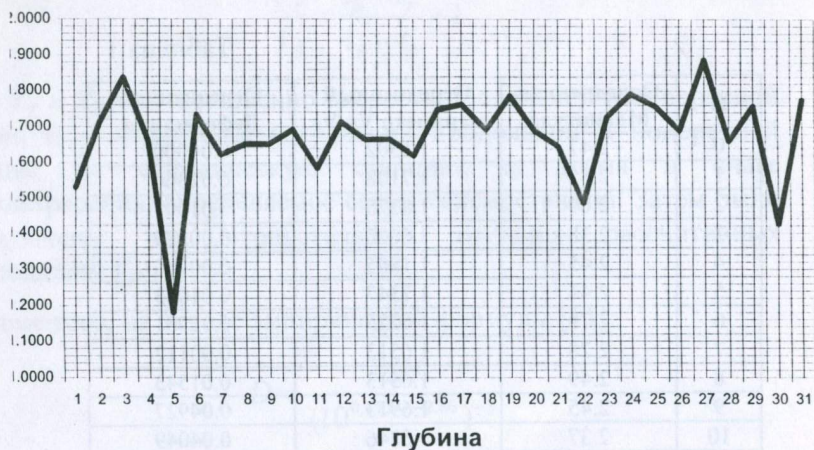
Рис.1. Средние значения параметра V_p/V_s по глубине.
