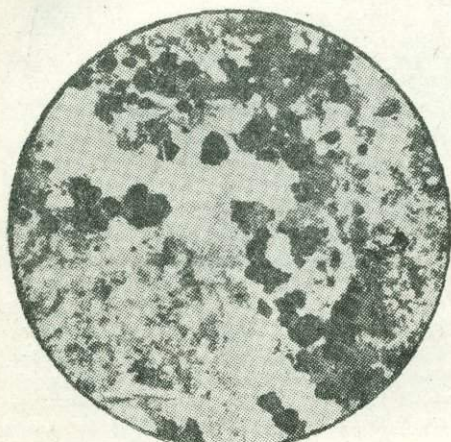
Рис. 23. Густая вкрапленность пирита во вторичном кварците. По облик можно усмотреть грани пентагонального додекаэдра
