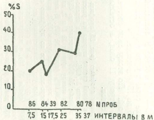
Рис. 53. Диаграмма качественной характеристики серного колчедана по 9 слою „Нового“ штока (поперечный профиль по южному контакту слоя)
