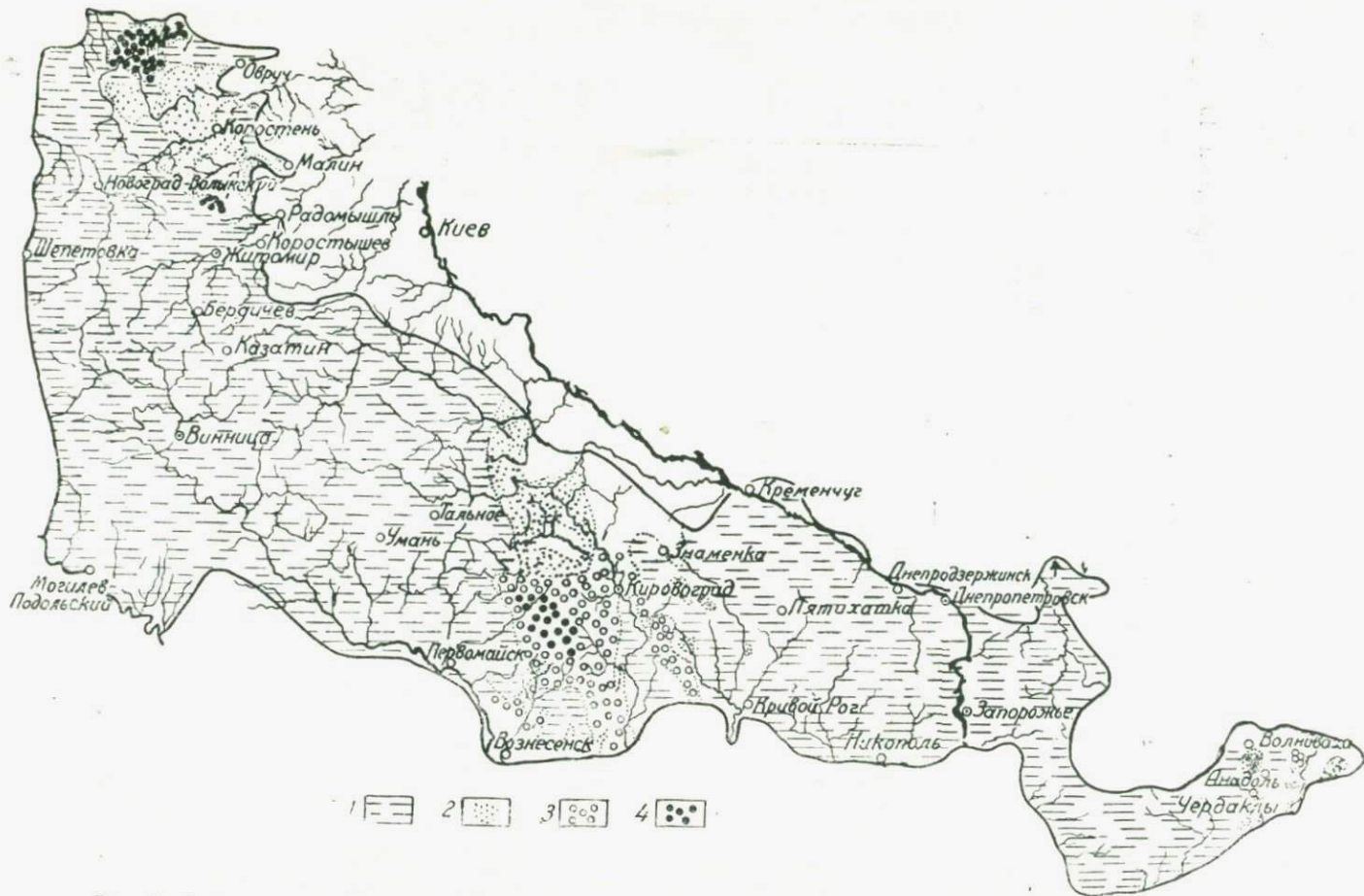
Рис. 7. Схема распределения гафния в породах Украинского кристаллического щита (масштаб 1:5 000 000). 1 — область распространения исходно-несмещенного типа - Nf : Zr ( K_{HfO_2} = 2,0 ); 2 — районы с пониженным содержанием гафния — K_{HfO_2} < 2 ; 3 — районы с повышенным содержанием гафния — K_{HfO_2} = 2,0-3,0 ; 4 — районы с высоким содержанием гафния K_{HfO_2} = 3,0-5,0 .
