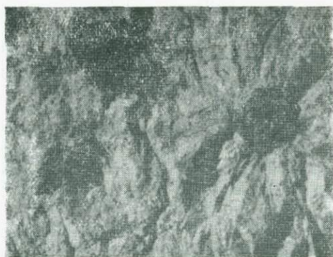
Рис. 17. Радиальная трещиноватость в кварце вокруг цирколита (в левом верхнем углу — гранат).
