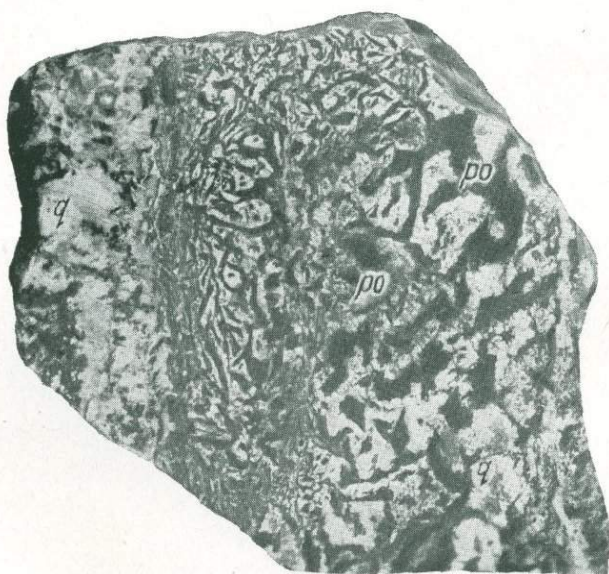
Фиг. 17. Кварцево-пирротиновая руда третьей стадии минерализации. Отполированный штуф. Садон, шахта им. Артема, 6-й горизонт (уменьш. в 2 раза).
