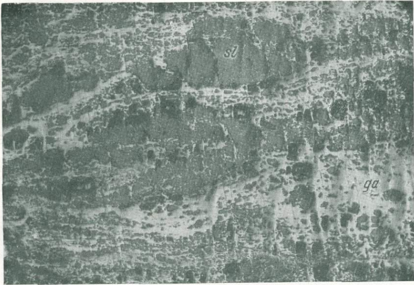
Фиг. 18. Коррозионная структура прорастания галенита (Ga) по сфалериту. Садон, Ходский участок, штольня № 17 (увелич. в 45).
