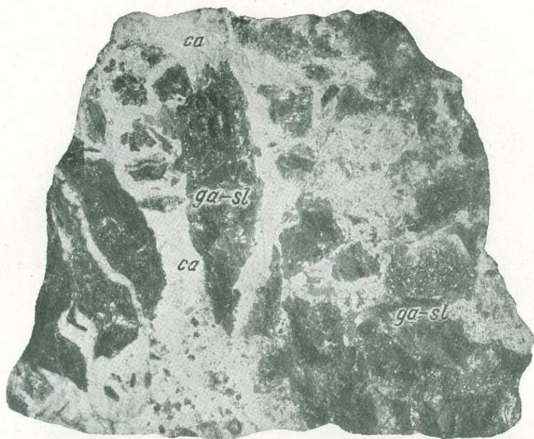
Фиг. 16. Галенит-сфалеритовая руда (Ga — Sb) второй стадии минерализации, пересеченная кальцитовыми прожилками (Ca), Садон, Ходский участок, штольня № 15 (уменьш. в 2 раза).
