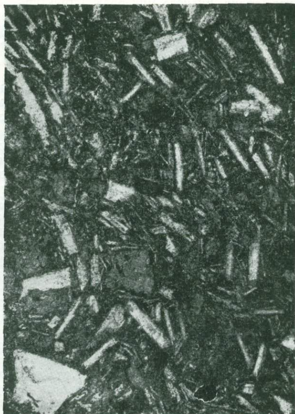
Фиг. 7. Шлиф № 1255. Баркевикитовый порфирит. × 20. Ник. +.
