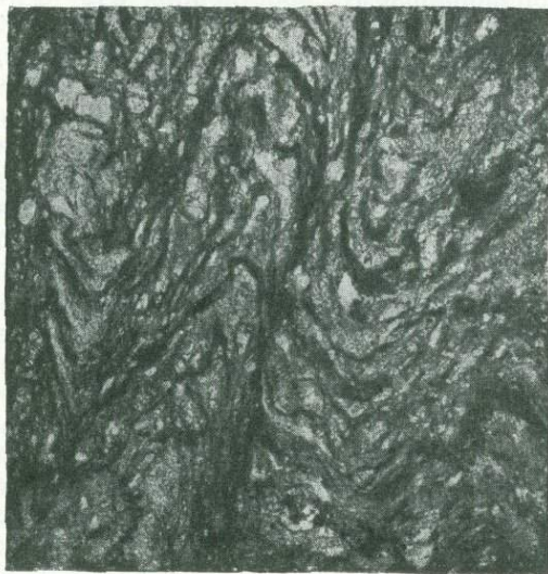
Фиг. 33. Плойчатость в эпидотизированном и расланцованном туфопесчанике тукурингрской свиты. \times 20 .
