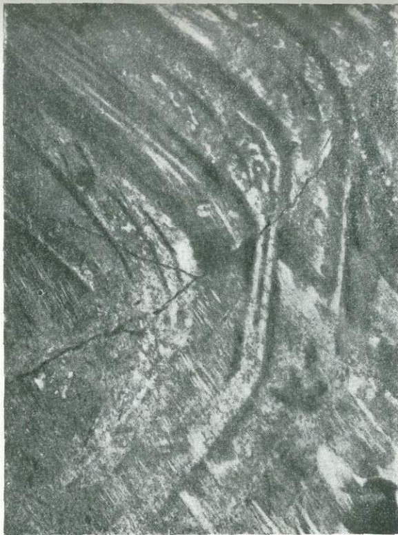
Фиг. 3. Шлиф № 66/48, гродековский гранит; зональное расположение пертитовых вростков в микроклине. \times 50 . Ник. +.
