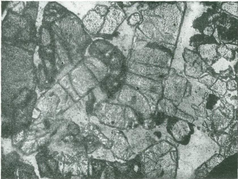
Фиг. 54. Апатит и гранат в альбитовой породе. \times 90 .
