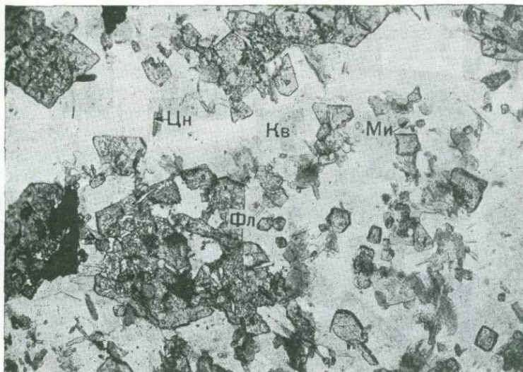
Фиг. 46. Кристаллы флюорита (Фл), микроклина (Ми), циннвальдита (Цн), арсенирита (черное) в кварцевом (Кв) грейзене. \times 46 . Ник. ||. Месторождение Баджиряевское.
