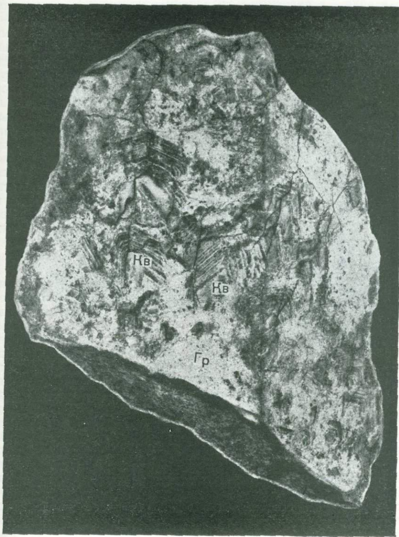
Фиг. 35. Метасоматическое замещение альбитизированного гранита (Гр) кварцем (Кв). Уменьшено в 1,5 раза. Месторождение Спокойное.
