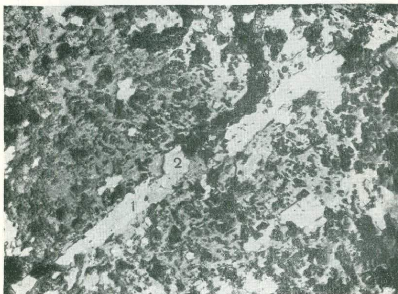
Фиг. 20. Колумбит (1) и вольфрамит (2) в касситерите. \times 450 . Аншлиф. Месторождение Этыкинское.
