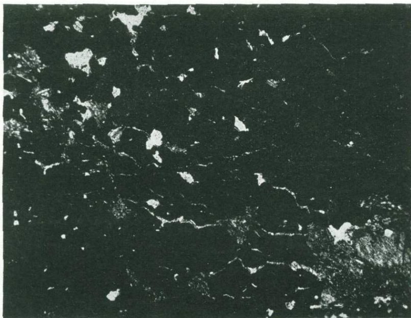
Фиг. 63. Магнетит с кальцитом и актинолитом. Шлиф № 235. \times 46 .
