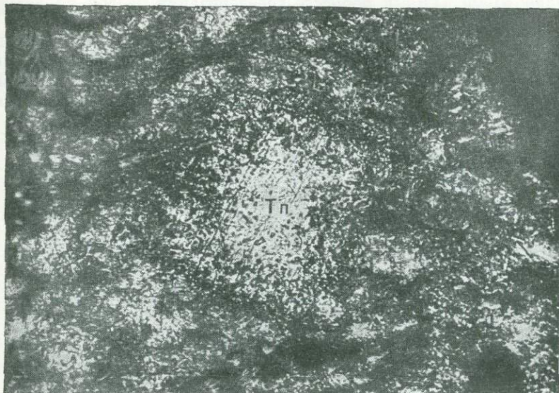
Фиг. 39. Замещение сланца топазом (Тп). \times 240 . Ник. ||. Месторождение Этыкинское.
