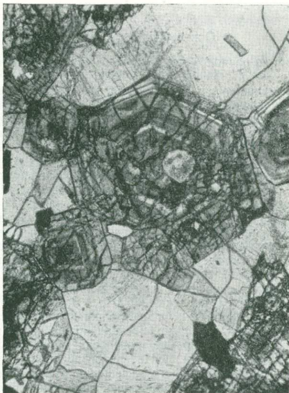
Фиг. 40. Шлиф № 1/49. Турмалин-флюоритовые оловянные руды; в центре зональные кристаллы турмалина. \times 46 . Ник. ||.
