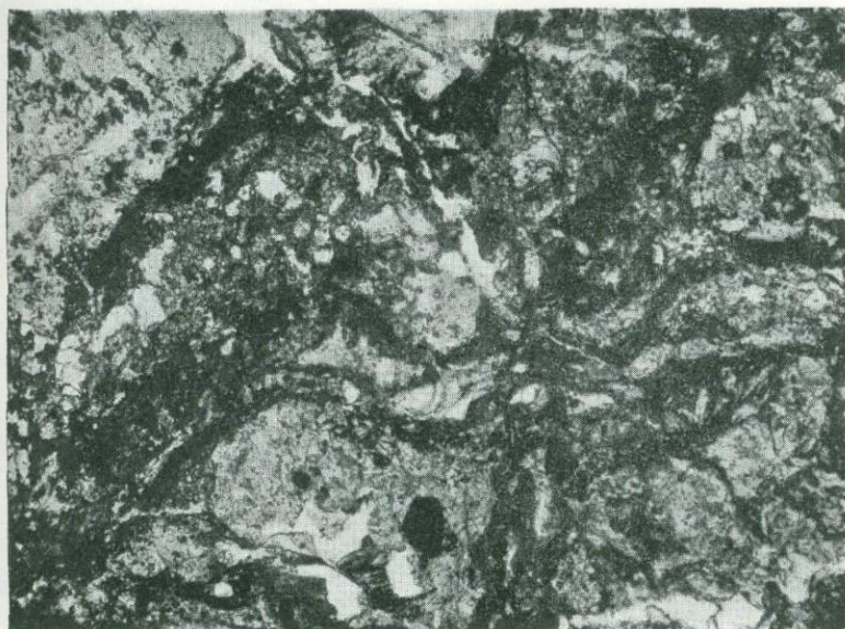
Фиг. 37. Брекчия гранита, сцементированная эпидотом, хлоритом и магнетитом. \times 46 .
