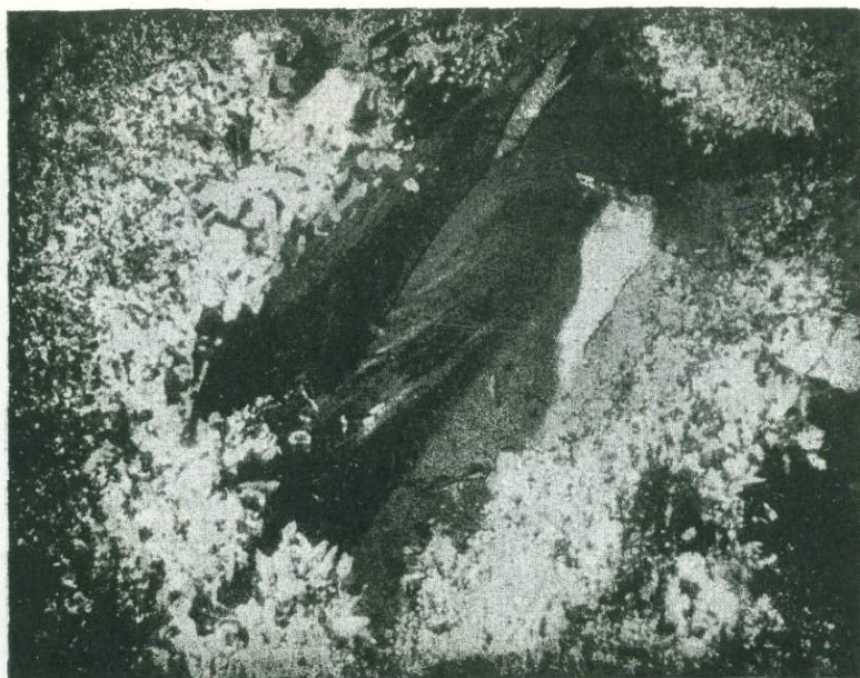
Фиг. 8. Аксинит с характерным пламенивидным угасанием и мелкозернистый геденбергит. \times 20 . Ник. +.
