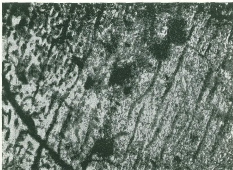
Фиг. 8. Вокруг включений рудного минерала (черный) окраска касситерита более темная (серый). \times 80 . Ник. ||. Месторождение Еруда.
