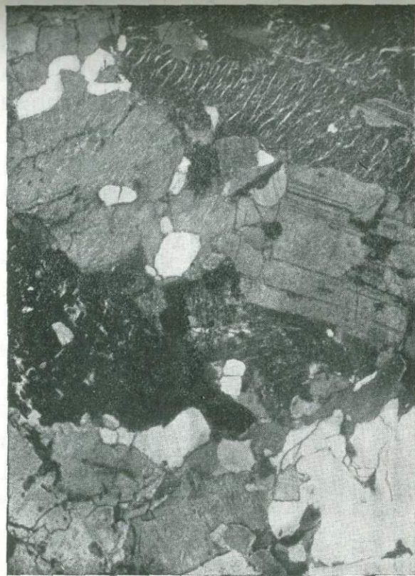
Фиг. 4. Шлиф № 2399, биотитовый гранит. \times 46 . Ник. +.
