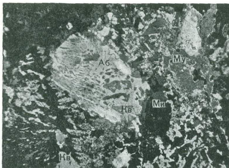
Фиг. 59. Графическая структура замещения альбита (Аб) и микроклина (Ми) кварцем (Кв) и мусковитом (Му). \times 32 . Ник. +. Месторождение Спокойное.
