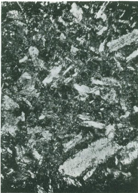
Фиг. 27. Шлиф № 4669. Кварцевый диорит-порфирит. \times 46 . Ник. ||.
