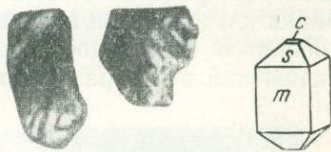
Фиг. 17. Короткопризматические кристаллы касситерита в жилах. \times 10 . Месторождение Этыкинское.
