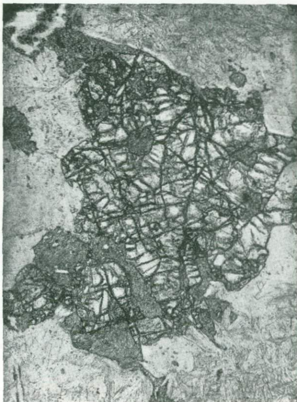
Фиг. 21. Шлиф № 1335а. Грейзенизированный гранит. Флюорит (темносерый) замещает топаз (светлосерый). \times 46 . Ник. II.
