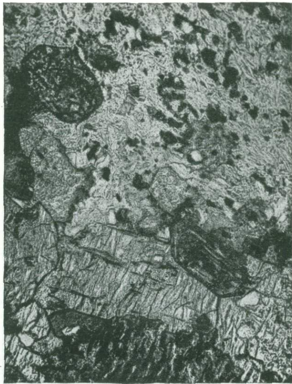
Фиг. 13. Шлиф № 295. Циркон в вознесенском грейзенизированном граните. Флюорит на контакте с цирконом окрашен в густофиолетовый цвет. \times 46 . Ник. ||.
