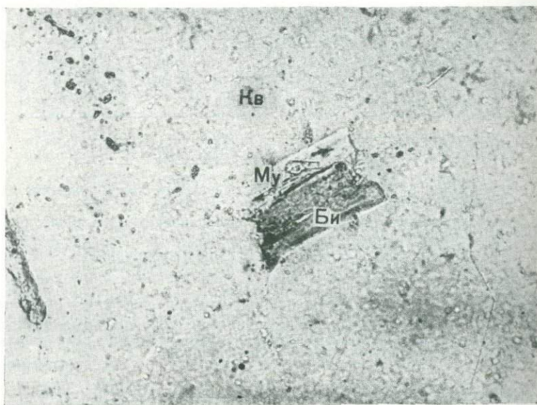
Фиг. 23. Биотит (Би) замещается мусковитом (Му) вблизи газожидких включений в кварце (Кв). \times 280 . Ник. ||. Месторождение Спокойное.
