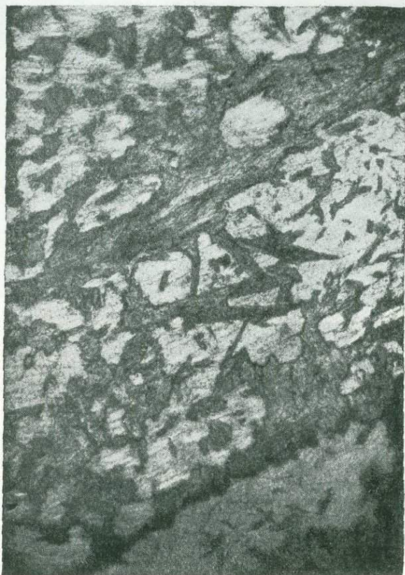
Фиг. 43. Шлиф № 857. Взаимоотношение флюорита (светлосерый) с литиевой слюдой (темносерая). \times 46 . Ник. ||.
