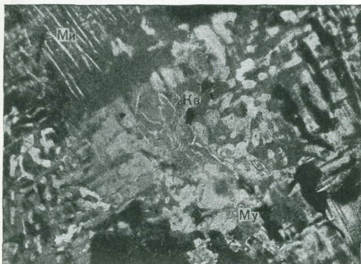
Фиг. 51. Микроклин (Ми) замещается кварцем (Кв) и мусковитом (Му).×72. Ник.+. Месторождение Спокойное.
