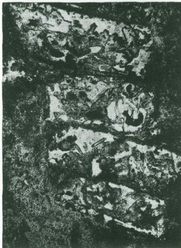
Фиг. 28. Шлиф № 2070 М. П. Материкова. Диорит-порфирит; замещение вкрапленников плагиоклазов слюдисто-флюоритовой рудой. \times 90 . Ник. II.
