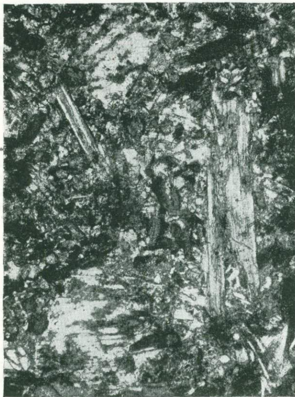
Фиг. 35. Шлиф № 1503. Баркевикитовый порфирит. × 20. Ник. ||.
