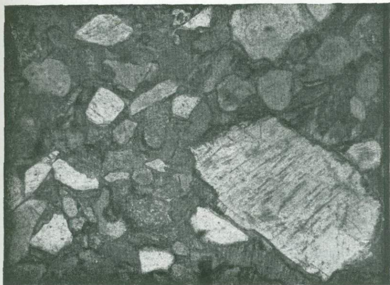
Фиг. 20. Неравнозернистый песчаник (D?). \times 46 .
