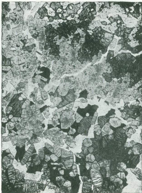
Фиг. 37. Шлиф № 370. Флюорит-турмалиновые оловянные руды. Взаимоотношение касситерита и турмалина. Турмалин разъедает кристаллы касситерита. × 35. Ник. ||.
