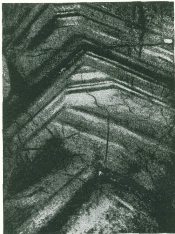
Фиг. 4. Зональный касситерит. Черные зоны касситерита с большим количеством колумбита и вольфрамита. Серые зоны касситерита с небольшим количеством колумбита и вольфрамита. \times 30 . Ник. II. Месторождение Этыкинское.
