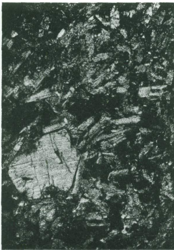
Фиг. 29. Шлиф № 2505. Диабаз-порфирит. \times 20 . Ник. +.
