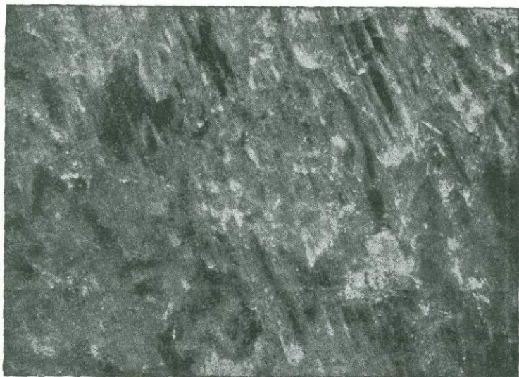
Фиг. 50. Кварц (серое и черное) замещает микроклин (белое) по спайности, сохраняя его строение. \times 8 . Месторождение Спокойное.
