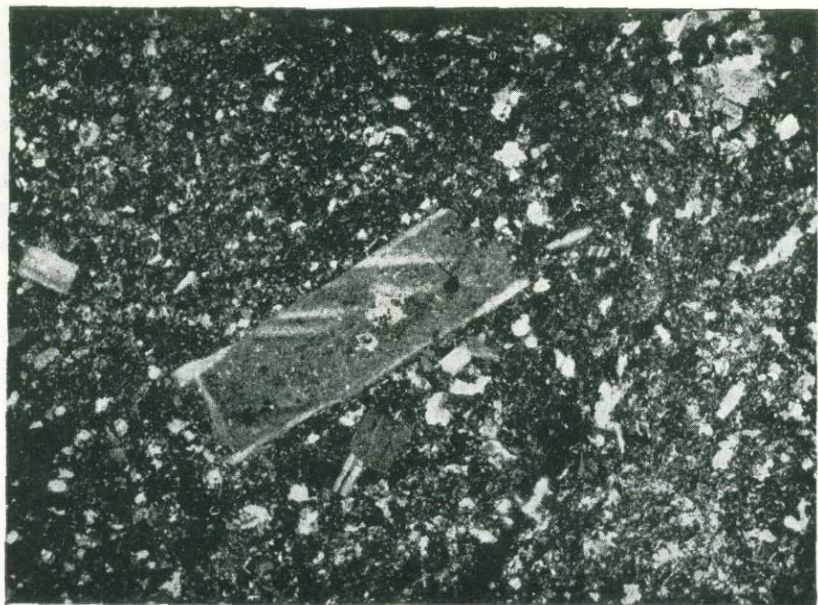
Фиг. 15. Липарит с удлинёнными включениями альбита. \times 20 . Ник. +.
