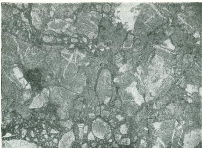
Фиг. 41. Брекчия гранита, сцементированная хлоритом и магнетитом. \times 20 .
