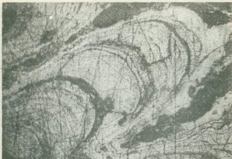
Рис.37. Столбчатые дендриты. Прозрачно-полированный шиф. x95.
