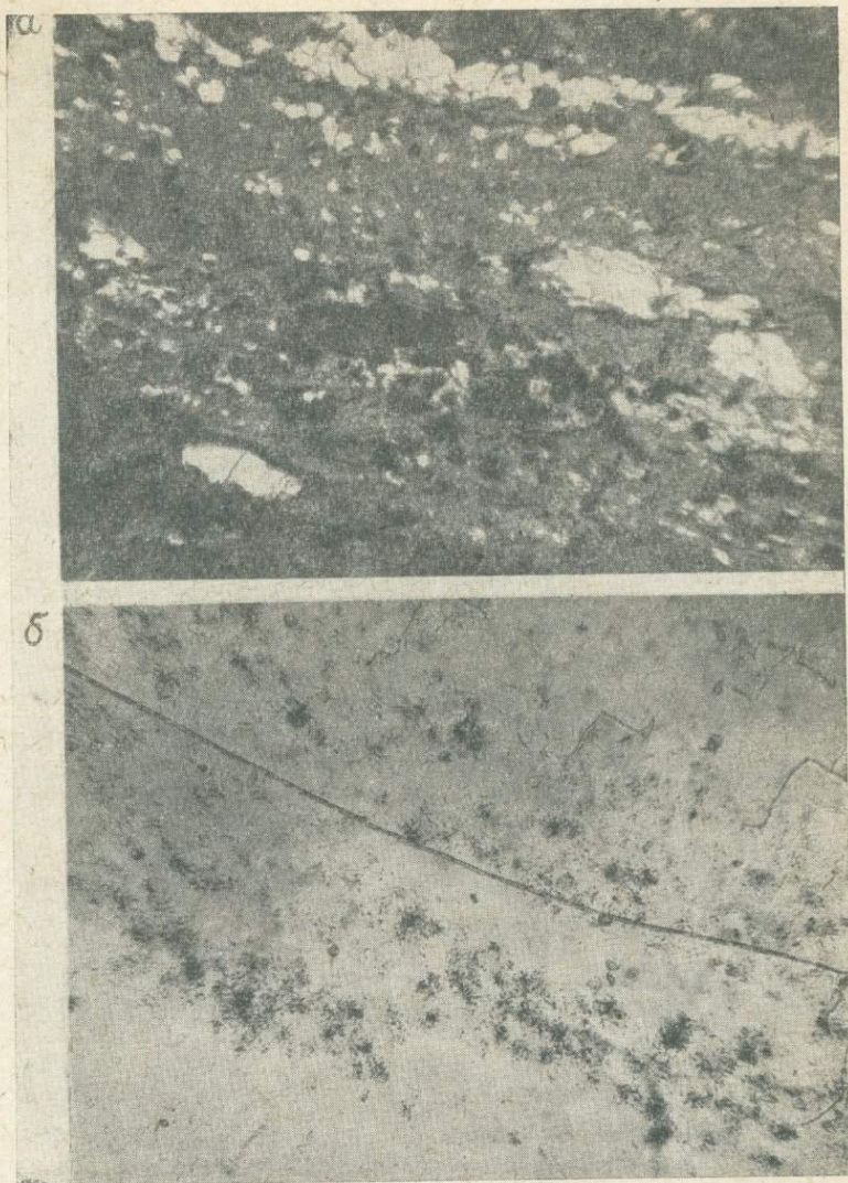
Рис. 24. Распределение урана в кварц-сланцевых сланцах по трекам осколков индуцированного деления U^{235} . а — шлиф, б — треки. Проходящий свет, ув. 100.
