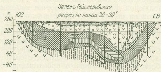
Рис. 64. Геологический разрез по разведочной линии 30—30' залежи Гейслеровская Джетыгаринского месторождения хризотил-асбеста. Составили Л. Я. Шишкова и А. И. Наумов.
