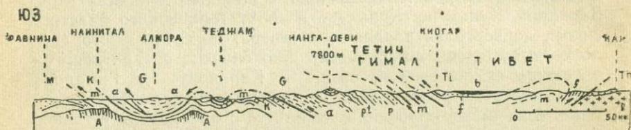
Рис. 11. Обобщенный тектонический разрез через Гималаи, по А. Гейму и А. Ганссеру:
