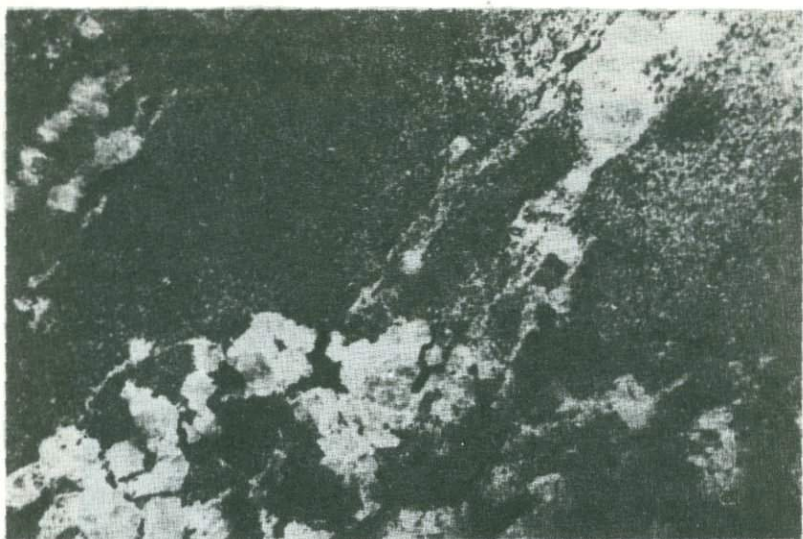
Рис. 2. Свечение насыщенных люминофором пор в порфиробластическом ийолите (свечение показывает повышенную пористость порфиробласт и следы „подводящих каналов“). ОИ-18, увел. 20.
