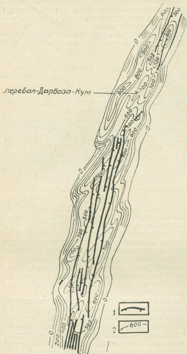
Рис. 4. Структурная карта антиклинали Арык-Тау по подошве бухарских слоев палеогена. 1 — линия разлома с направлением падения сместителя; 2 — изогипсы; а — четные; б — нечетные.
