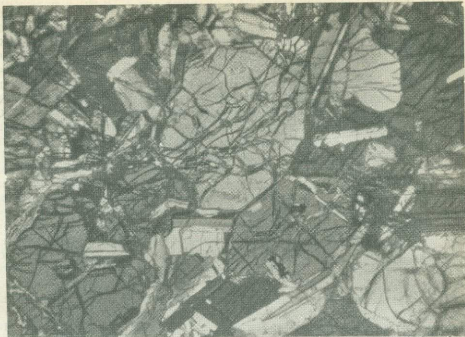
Рис. 5. Пикритовый габбро-долерит с хорошо ограниченными кристаллами оливина и системой субпараллельных микротрещин. Структура сегрегационная. Николит+, увел. 25, шл. 575
