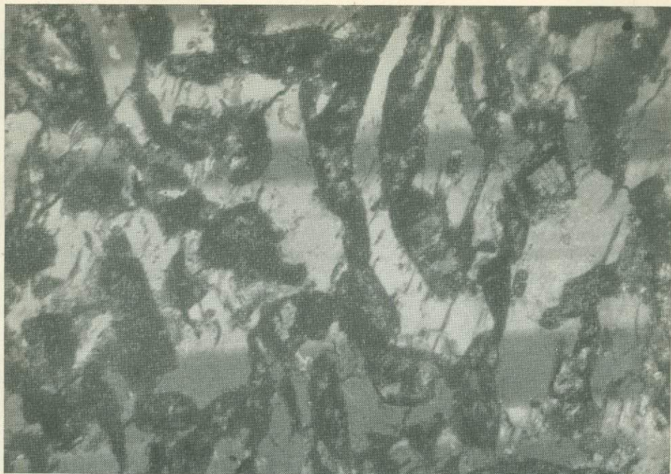
Рис. 7. Пегматоидный габбро-долерит. Закономерные вросстки клинопироксена в плагиоклазе. Пегматитовая (графическая) структура. Николи+, увел. 40, шл. 552а
