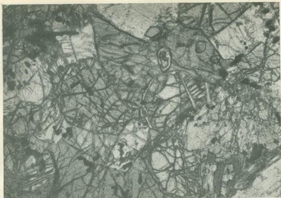
Рис. 50. Пикритовый габбро-долерит вблизи контакта с оливиновым габбро в интрузии Норильск I. Николи ||, увел. 30, шл. 954в
