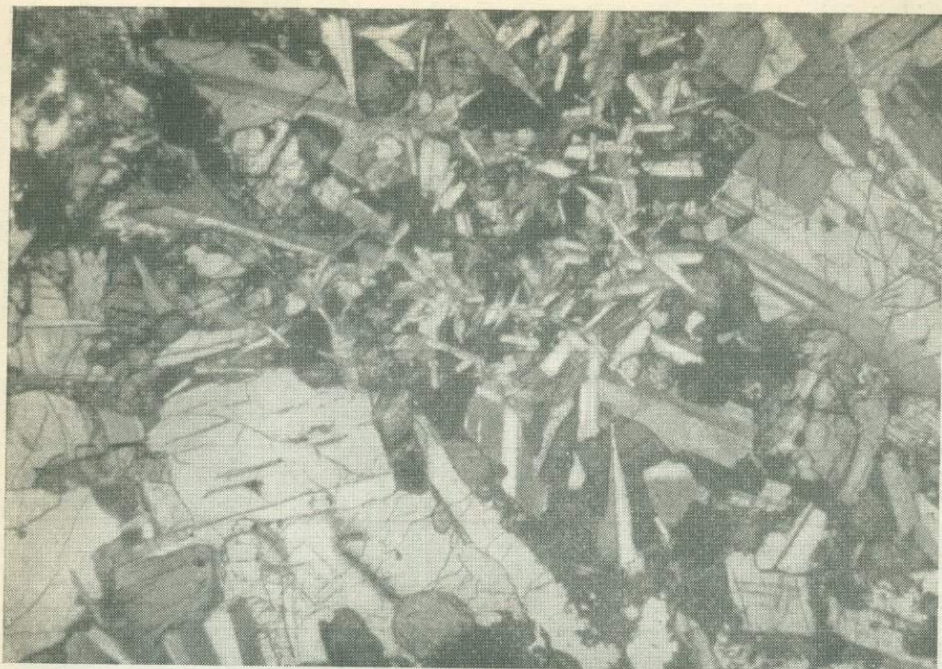
Рис. 8. Верхний такситовый габбро-долерит. Хорошо видны крупные таблицы плагиоклаза первой генерации и мелкие лейсты плагиоклаза второй генерации, пойкилитово включенные в зерна клинопироксена. Николи+, увел. 12, шл. 745в
