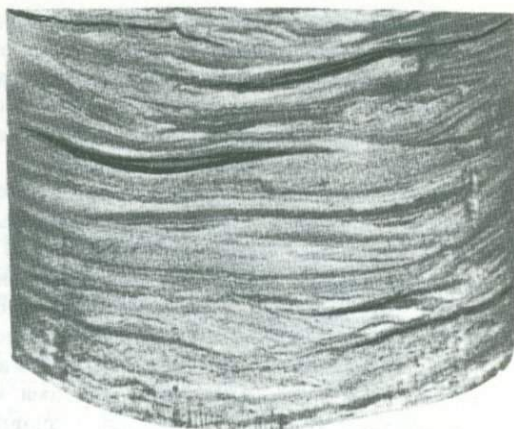
Рис. 10. Тонкая горизонтальная слоистость в песчанике мелкозернистом за счет обильного обугленного растительного детрита на поверхностях наслоения, Белозёрское месторождение
