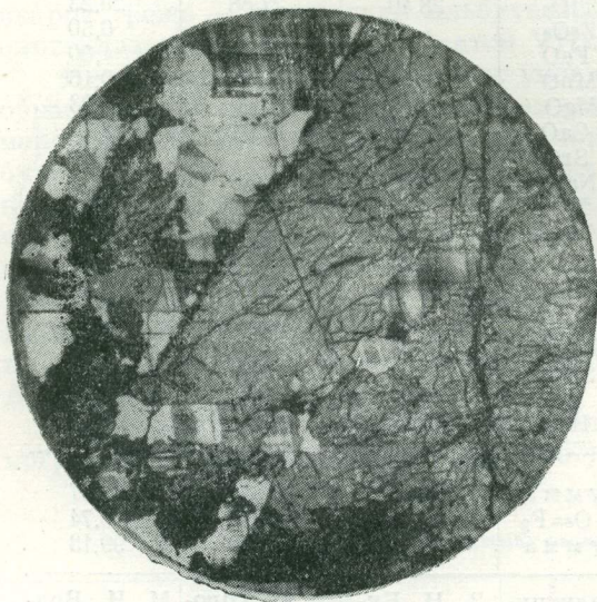
Рис. 47. Реликты микроклина в иттротитаните (серое с рельефом), имеющие идентичную оптическую ориентировку с окружающим иттротитанитом микроклином. В периферической части метакристаллы иттротитанита замещаются ильменитом (черное). Участок VII, жила 5. \times 15 , николи скрещены
