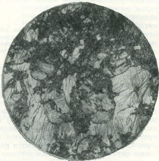
Рис. 56. Цепочки мелкозернистого агрегата циртолита (темно-серое) рассекают и замещают метакристаллы абукумалита (серое с рельефом); белое — кварц. Участок IV, жила 42. \times 15 , без анализатора
