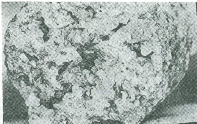
Рис. 6. Пористый друзо-подобный агрегат калишпата (калишпатит).
