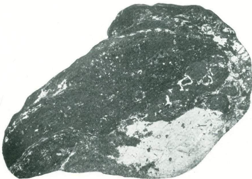
Рис. 102. Гнездово-вкрапленная текстура. Гнезда и неправильная вкрапленность сульфидов (светло-серое и серое) в гранат-биотит-амфиболовой породе (темно-серое). Оруденелая экзоконтактовая порода ( V_1 ). Аллареченский район. Полир. штупф, нат. вел. Коллекция Ю. Н. Яковлева.
