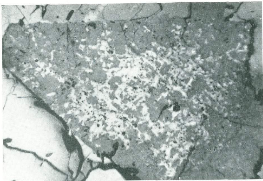
Рис. 173. Субграфическая структура распада твердого раствора пентландита (светло-серое) в пирротине (серое).
