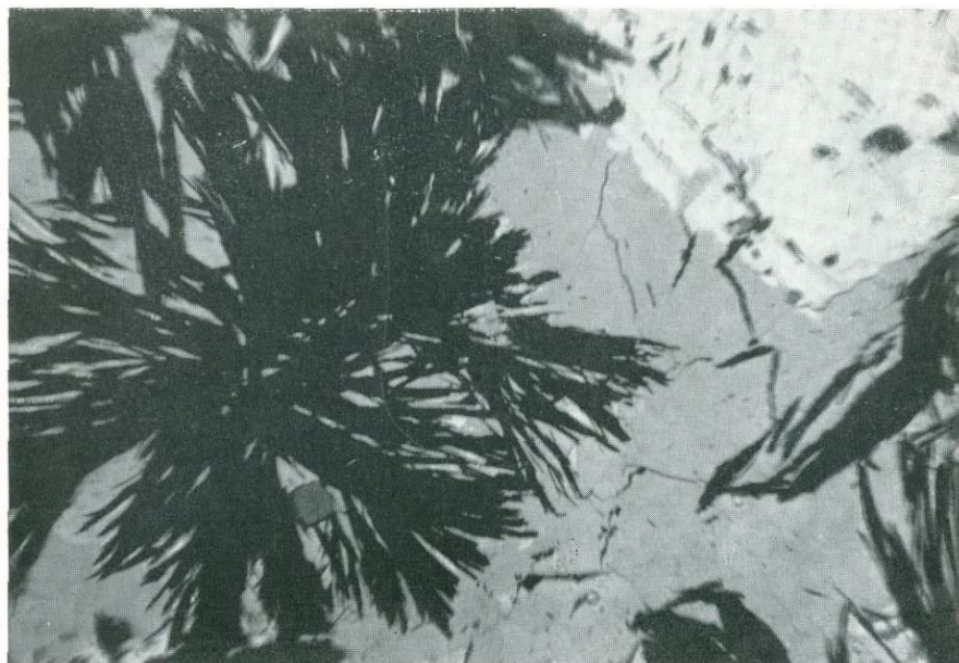
Рис. 190. Радиально-лучистая структура агрегата антигорита (черное) в пирротине (светло-серое).
