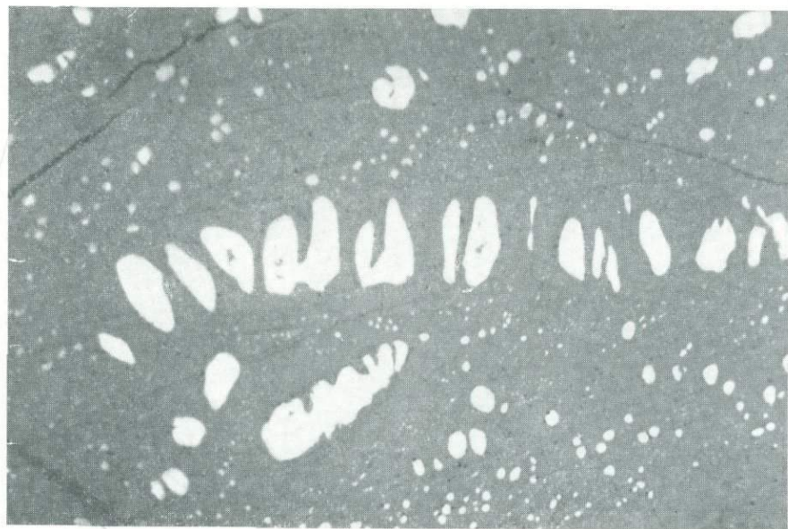
Рис. 165. Графически-эмульсионная структура распада твердого раствора.
