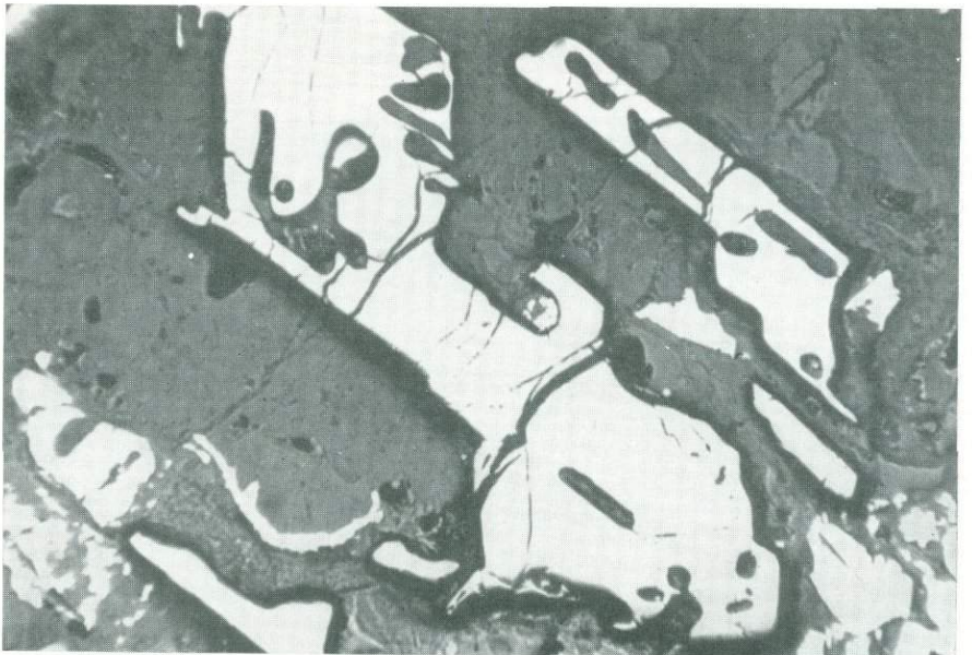
Рис. 215. Скелетный монокристалл ильменита (серое) в серпентините (черное). Рассеянно-вкрапленная руда (I 1 ). Печенгский район. Аншлиф, при одном никеле, \times 60 . Коллекция Ю. Н. Нерадовского.
