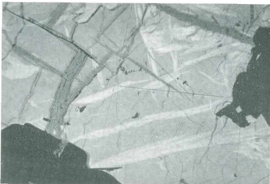
Рис. 169. Линзовидно-решетчатая структура распада твердого раствора пентландита (светло-серое) в халькопирите (серое).
