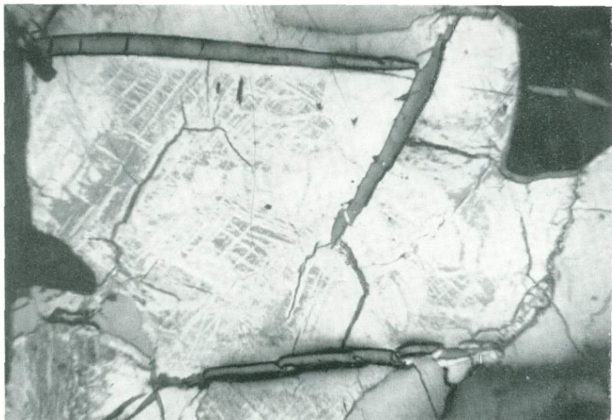
Рис. 180. Ячеисто-решетчатая структура распада твердого раствора макинавита (серое) и пентландита (светло-серое).
