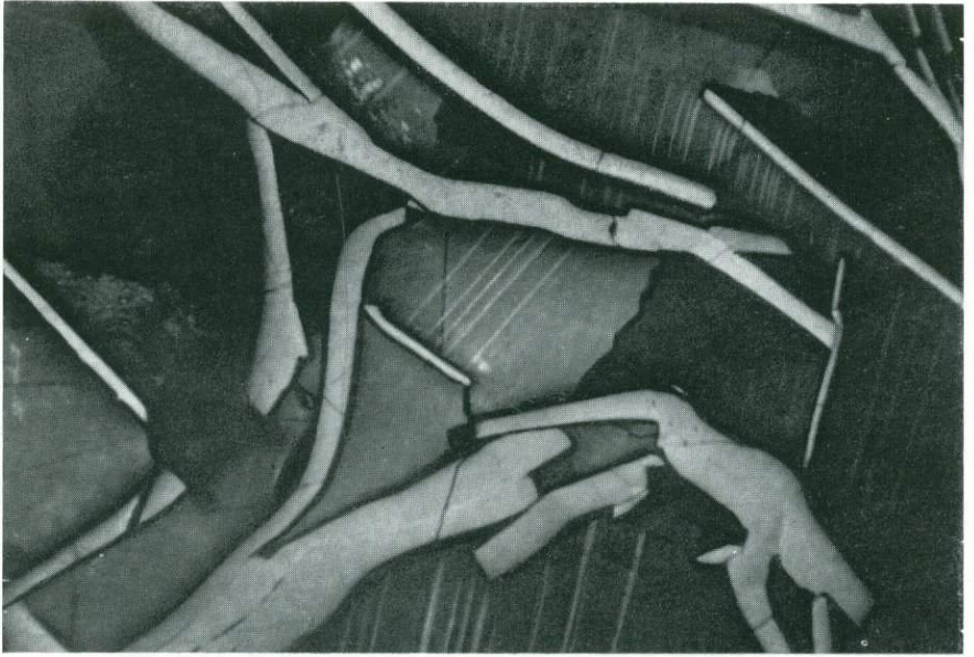
Рис. 232. Изогнутые пластинчатые кристаллы пирротина (светлое) в кальците (сдвойникованные зерна). Оруденелая вмещающая порода (VI). Печенгский район. Аншлиф, при одном николе, \times 40 . Коллекция Ю. Н. Нерадовского.
