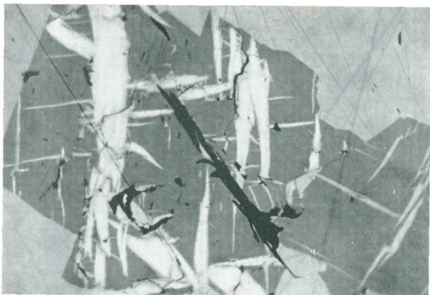
Рис. 182. Решетчатая структура распада твердого раствора халькозина (белое) и борнита (темно-серое). Серое — халькопирит. Густо-вкрапленная руда (II 2 ). Печенгский район. Аншлиф, при одном никеле, \times 700 Коллекция Ю. Н. Нерадовского.
