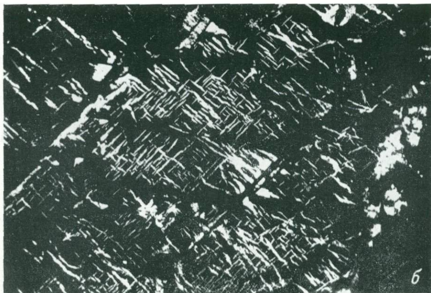
Рис. 179. Решетчатая структура распада твердого раствора макинавита (серое) в пентландите (светло-серое).
