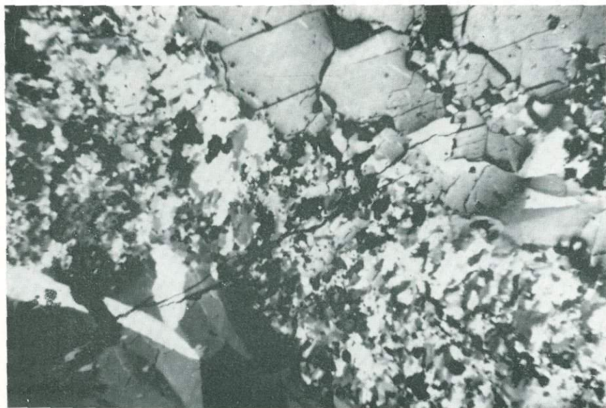
Рис. 197. Гранобластическая структура пирротина с неотчетливой ориентировкой индивидов
