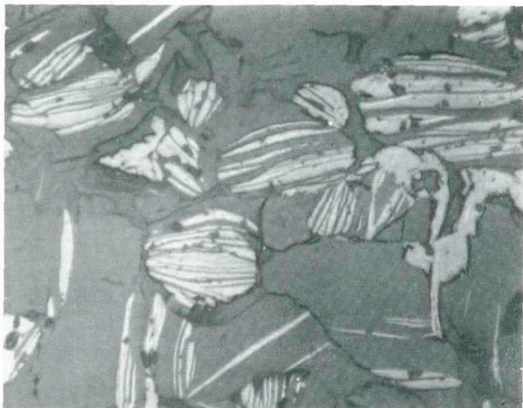
Рис. 208. Линзовидные выделения позднего магнетита (светло-серое) в хлорите и флогопите (темно-серое). Рассеянно-вкрапленная руда (I 1 ). Аллареченский район. Апплиф, при одном никеле, \times 200 . Коллекция Ю. Н. Яковлева.
