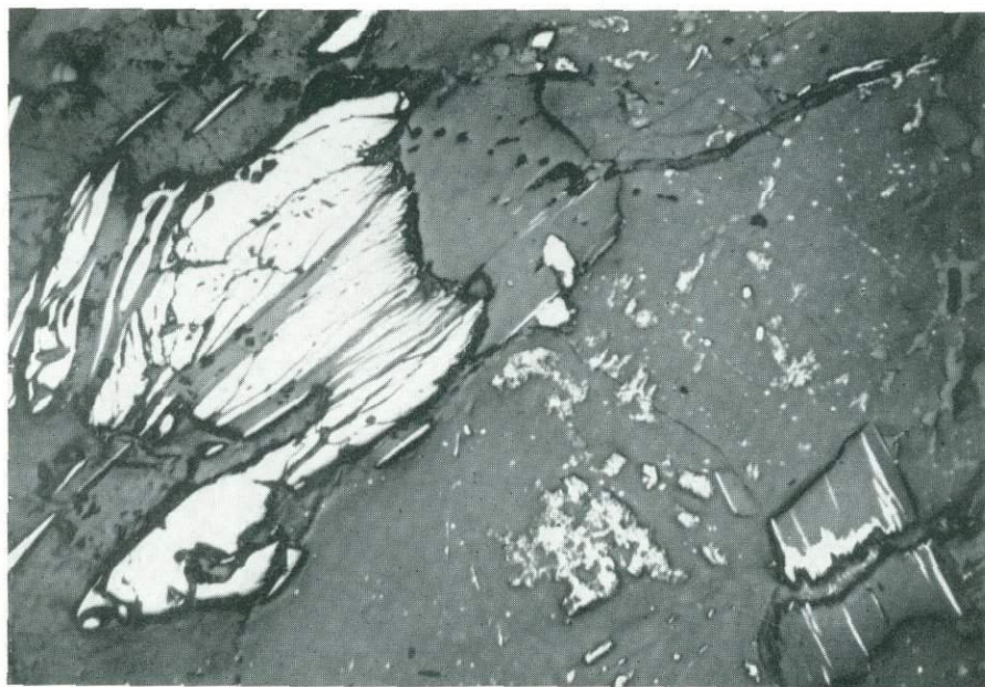
Рис. 209. Эмульсионные, прожилковые и линзовидно-пятнистые выделения позднего магнетита (белое) во вторичных силикатах ультраосновных пород (темно-серое).
