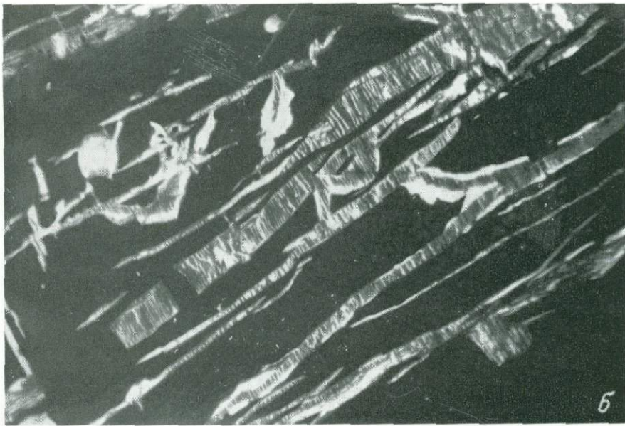
Рис. 224. Поперечно-шестоватое строение прожилков макинавита (серое) в пентландите (светло-серое).
