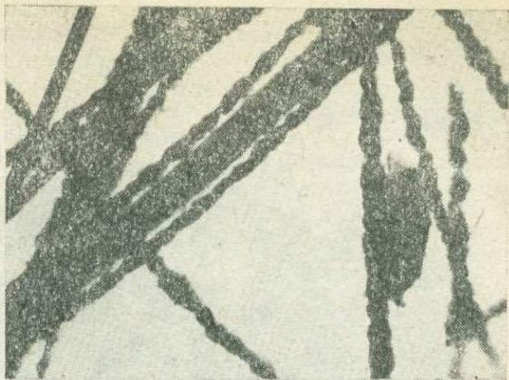
Рис. 4. Электронно-микроскопический снимок углеродистого вещества, отлагающегося на нитевидных кристаллах амфибола в высокотемпературной зоне. Увел. 9300.
