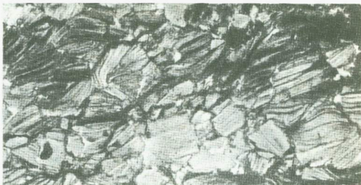
Фиг. 16. Каолинит-гетитовая порода по биотитовому сланцу. Каждая чешуйка почти нацело сложена каолинитом с примесью гетита и реликтами слюды. Без анализатора, увел. 45
