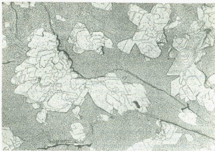
Фиг. 35. Электронно-микроскопическая фотография поверхности скола слабо выветрелого микроклина по (001). Кристаллы каолинита (светлое) толщиной несколько элементарных слоев замещают микроклин (серое). Декорирование золотом. Увел. 30 000
