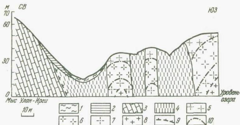
Фиг. 18. Схематический профиль коры выветривания на гранитах в районе мыса Улан-Ирги
