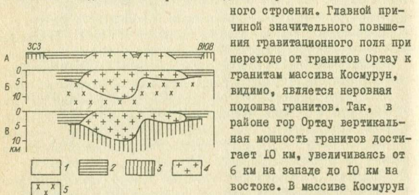
Рис. 3. Геологический (А) и расчетные (Б, В) разрезы по расчетному профилю (участок Ортау-Космурун).
