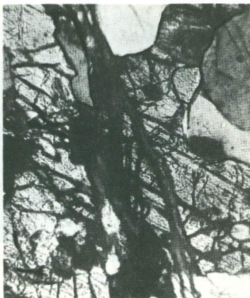
Фиг. 43. Невыветрелый амфиболовый гнейс с прожилками инфильтрационного нонтронита; обр. 316-1; увел. 75; николи ×
