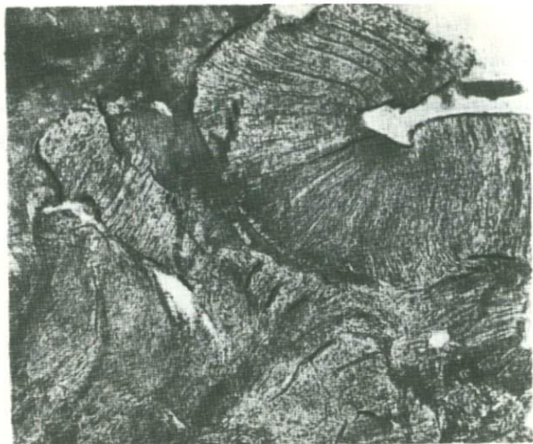
Фиг.45. Каолинизированный амфиболит, частично замещенный нонтронитом; обр. 316-13; увел. 150; николи ×
