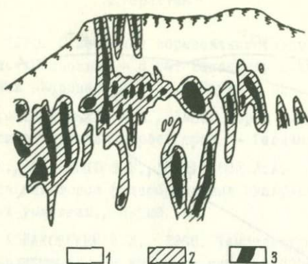
Рис. 4. Проекция на вертикальную плоскость свинцового оруденения для одного из участков Садонского рудного поля I - безрудные участки; 2 - бедные руды; 3 - богатые руды.
