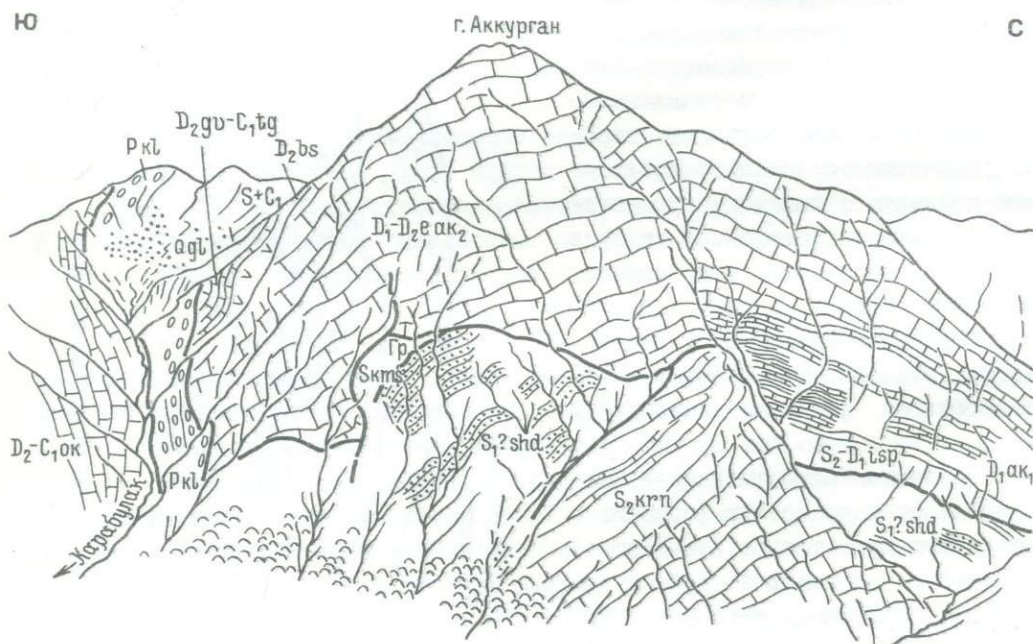
Рис.17. Ядро Баубашатинской антиклинали в долине р.Караункюр. Разрез осложнен надвигом в подошве известняковой серии.
