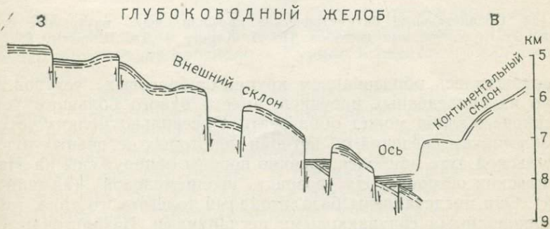
Рис. 13. Сейсмический профиль по отраженным волнам через Чилийский желоб, показывающий разрывы в фундаменте под толщей турбидитов. По У. Швеллеру и Л. Кульму (1978 г.). Пунктир — поверхность второго слоя
