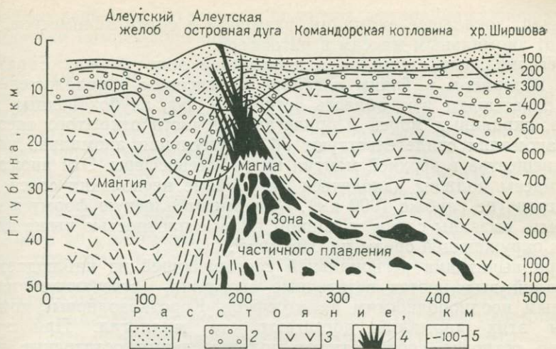
Рис. 22. Изотермы в коре и верхней мантии по профилю через Алеутскую островную дугу и прилегающие впадины. По Я. Б. Смирнову и В. М. Сугрובову [40].
