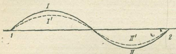
Фиг. 1. Положительная ( I' ) и отрицательная ( II' ) волны, развившиеся при расширении; последующее состояние волн ( I и II ) — результат наступившего сжатия; точки I и 2 не сближаются.
