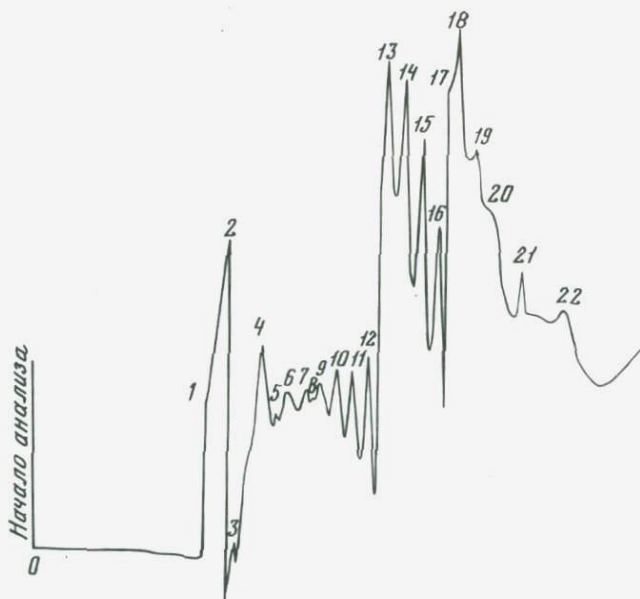
Рис. 6. Газожидкостная хроматограмма ацетонового экстракта пепла вулкана Тятя Условия опыта: хроматограф ЛХМ-8МД (модель 5) с пламенно-ионизационными детектором: колонка — стальная, длина 2 м, диаметр 4 мм, стационарная фаза — 50% SE-30 на хромосорбе W, газ-носитель — \text{H}_2 (30 мл/мин), начальная температура — 100°С, скорость программированного нагрева — 4°С в мин
