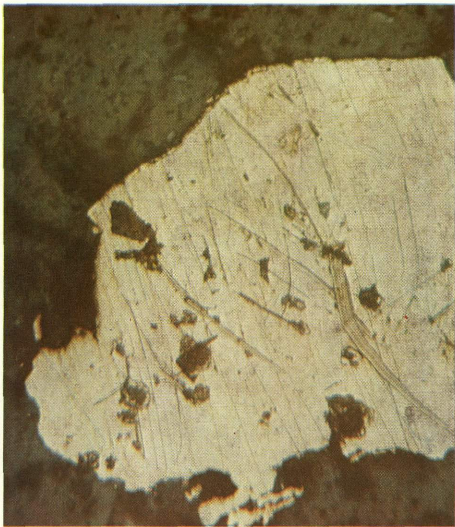
132 Двойники в крупном зерне золота. Золото-кварцевые жилы. Средние глубины. Южный Урал. Монтированный полированный шлиф 2-У. Без травления. Ув. 160
