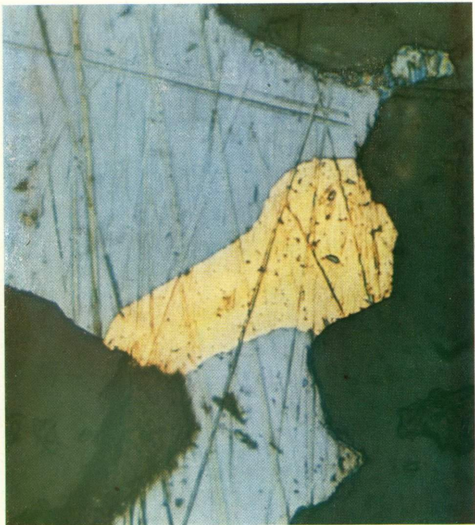
234 Золото рассекает галенит в сером кварце. Кварц-карбонатные жилы. Большие глубины. Карпаты. Полированный шлиф 3 6 . Ув. 850
