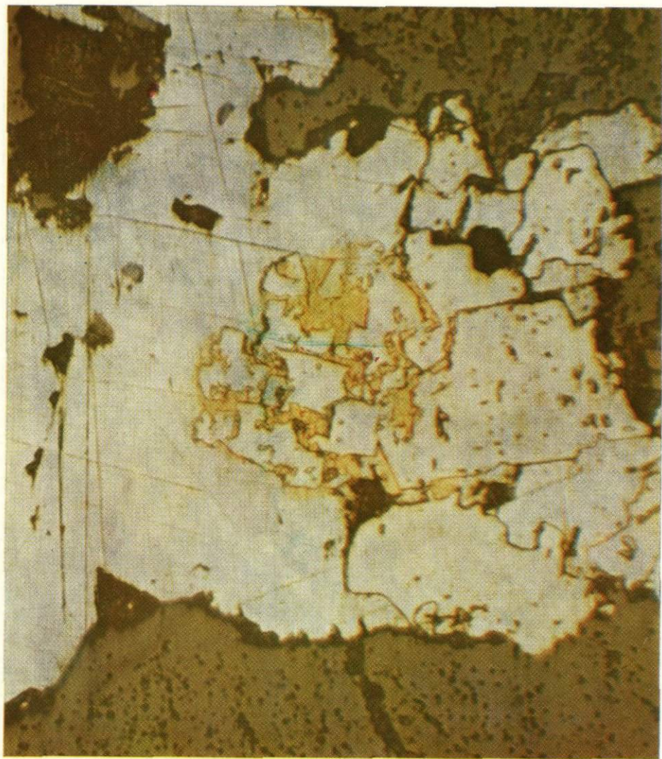
218 Выделение золота «заячья пегля» в метакристалле пирита. Кварцевые жилы. Большие глубины. Карпаты. Полированный шлиф 217. Ув. 450
