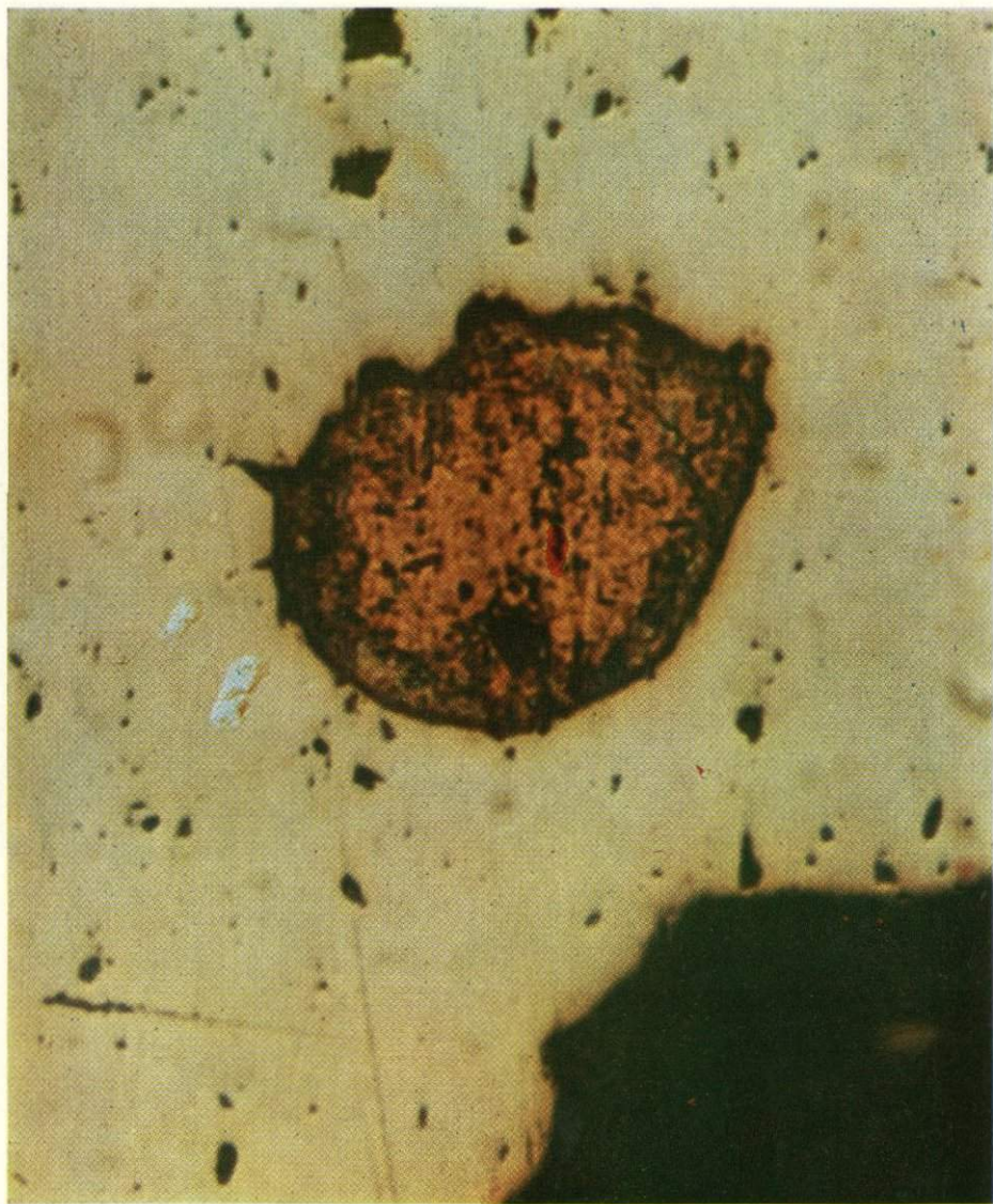
178 Выделение золота, сингенетичного с пиритом. Кварц-сульфидные жилы. Средние глубины. Средний Урал. Полированный шлиф 2049. Ув. 1000
