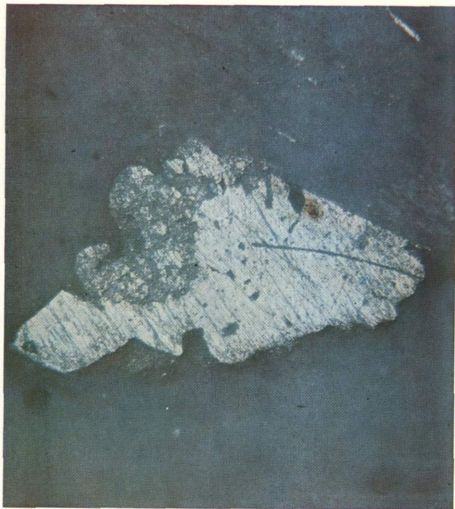
128 Широкий двойник в зерне золота. Кварц-баритовые жилы. Малые глубины, Закарпатье. Монтированный полированный шлиф 6 + . Травлено царской водкой. Ув. 160
