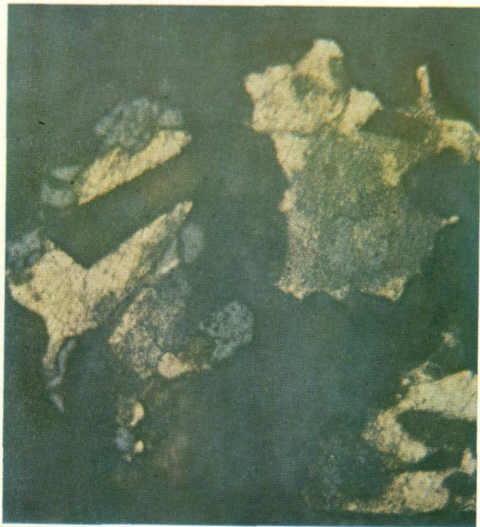
138 Зона высокопробного золота по границам золота первой генерации. Золото второй генерации перекристаллизацией не затронуто. Большие глубины. Карпаты. Монтированный полированный шлиф 7547-А. Травлено раствором \text{CrO}_3 в \text{HCl} (1:1). Ув. 480
