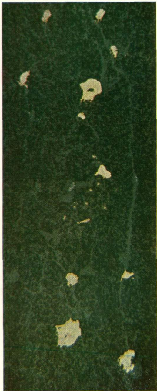
214 Золото в хлорит-серицитовом сланце. Кварц-карбонатные жилы. Большие глубины, Карпаты. Полированный шлиф 3558-1. Ув. 300
