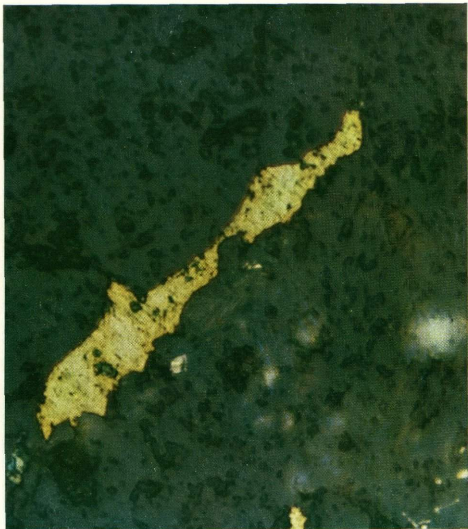
98. Прожилки золота в голубом кварце. Кварц-карбонатные жилы. Большие глубины. Карпаты. Подированный шлиф 3512-1. Ув. 850
