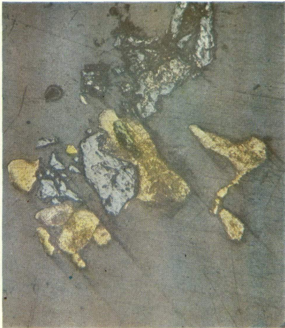
136 Зернистость золота, сросшегося с лимонитизированным пиритом, и отдельные зерна его. Кварц-сульфидные жилы. Большие глубины. Карпаты. Монтированный полированный шлиф 7347-1. Травлено царской водкой (1:1). Ув. 160
