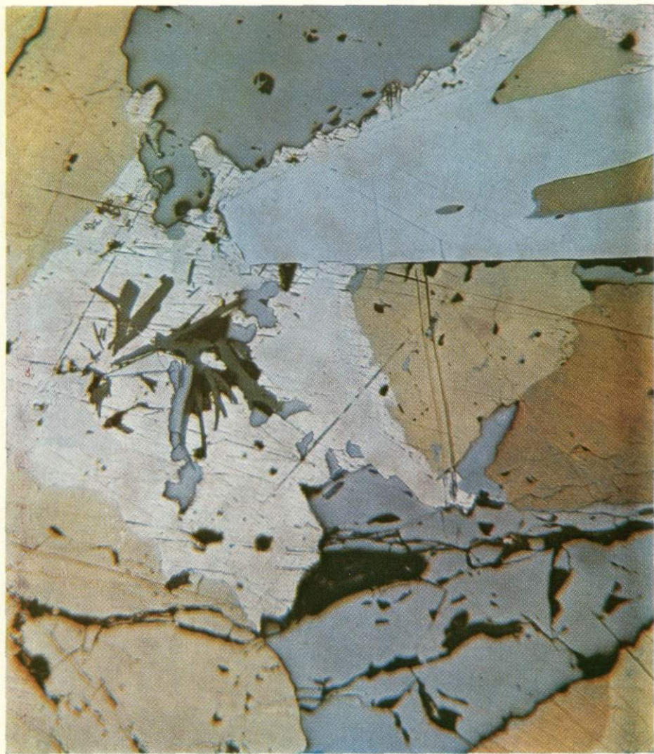
258 Кайма кyanита вокруг сперрилита и плюмбопалладинита. Норильский тип. Полированный шлиф 2089. Ув. 170. Образец А. Д. Генкина
