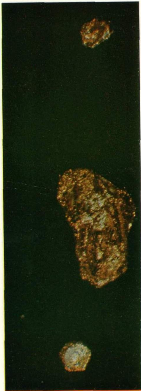
10 Совершенные кристаллы золота с ямчатым (блюдцеобразным) рельефом граней. Кварц-баритовые жилы. Малые глубины. Закарпатье. Обр. 7437. Ув. 190
