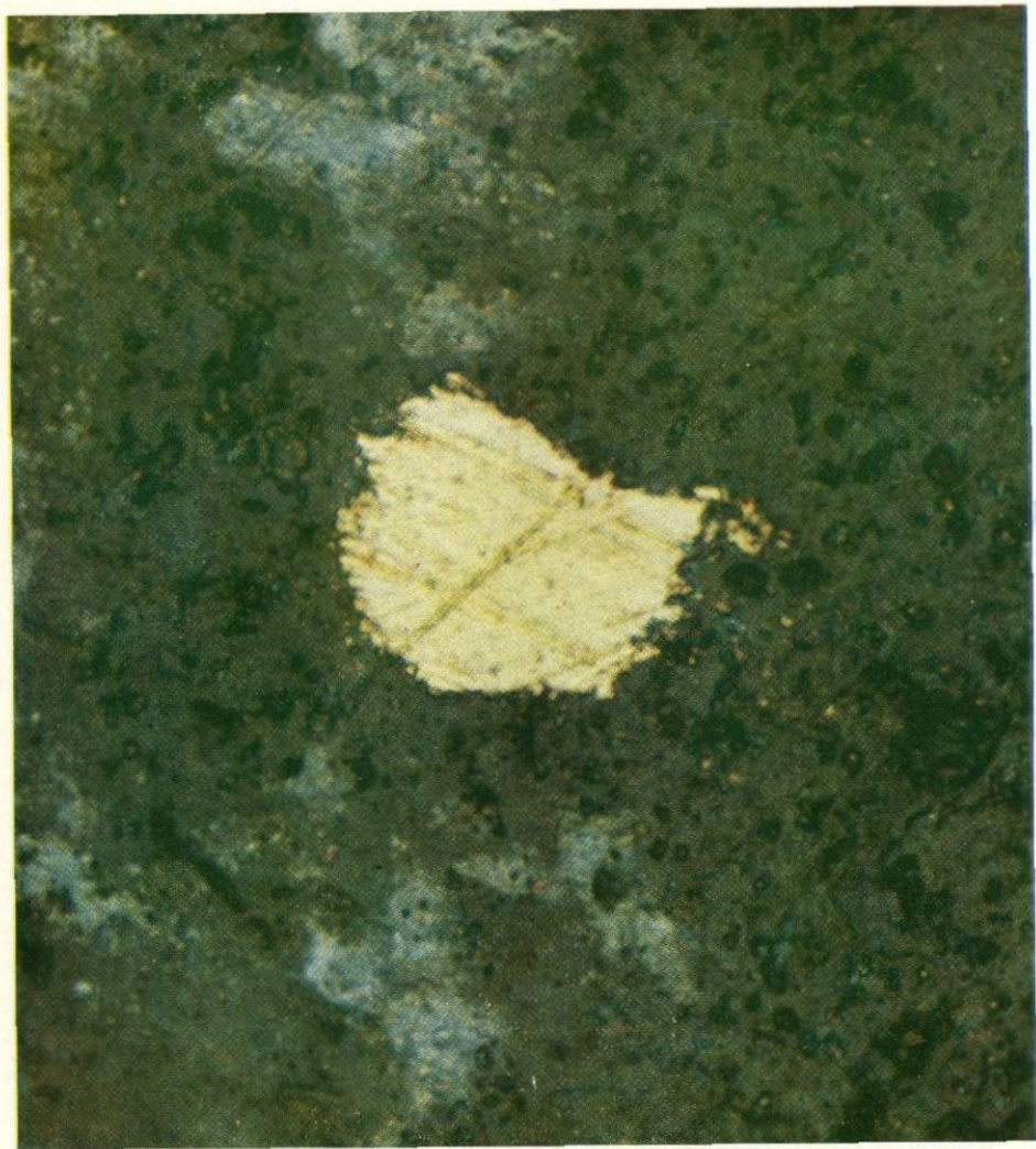
170 Изометрическое зерно золота в измененном кварцевом риолите. Кварц-баритовые жилы. Малые глубины. Закарпатье. полированный шлиф 6^{\nu-2} . Ув. 800
