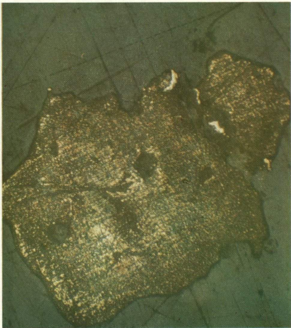
144 Межзерновые прожилки позднего высокопробного золота среди зерен золота. Делювий. Донбасс, Нагольный кряж. Монтированный полированный шлиф 5 a . Травлено царской водкой (1:1). Ув. 280
