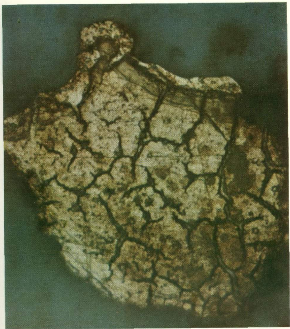
121 Зернистая структура золота, Кварц-баритовые жилы. Малые глубины, Закарпатье. Монтированный полированный шлиф 7432 a . Травлено царской водкой. Ув. 900
