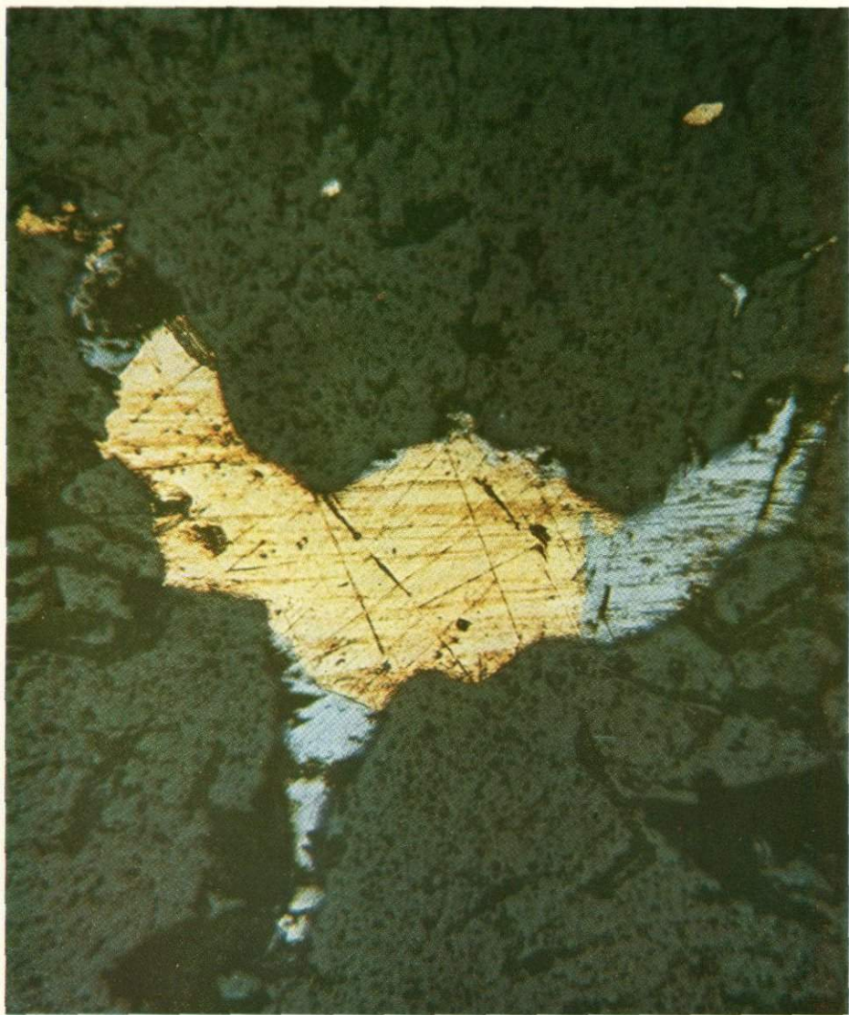
252 Золото в сростании с алтаитом (белое) в сером кварце. Кварц-карбонатные жилы. Большие глубины. Карпаты. Полированный шлиф 3-10. Ув. 180
