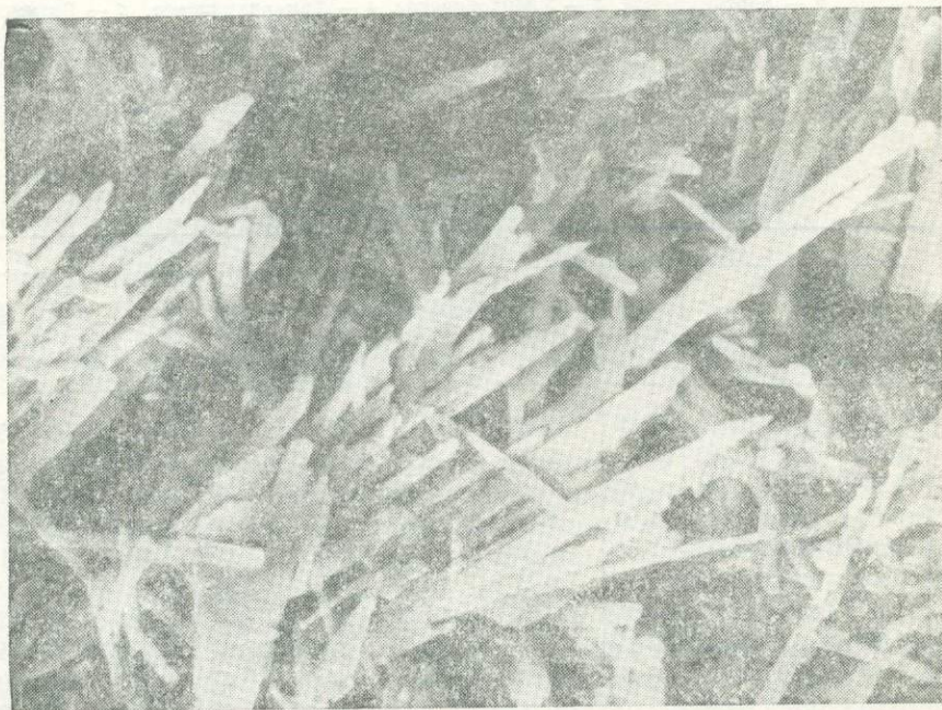
Рис. 40. Электронно-микроскопический снимок апогипербазитового нефрита. Увел. 2000.
