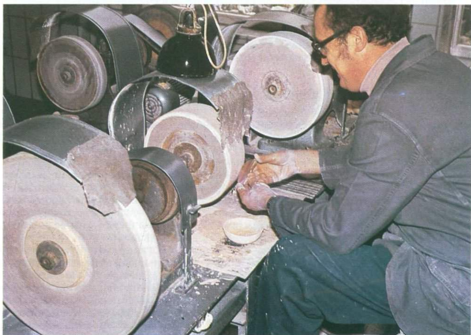
Вверху слева: резка агата. Вверху справа: шлифовка агата на круге из песчаника. Внизу: полировка агата.
