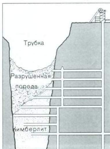
Подземная разработка месторождения в кимберлитовой трубке.
