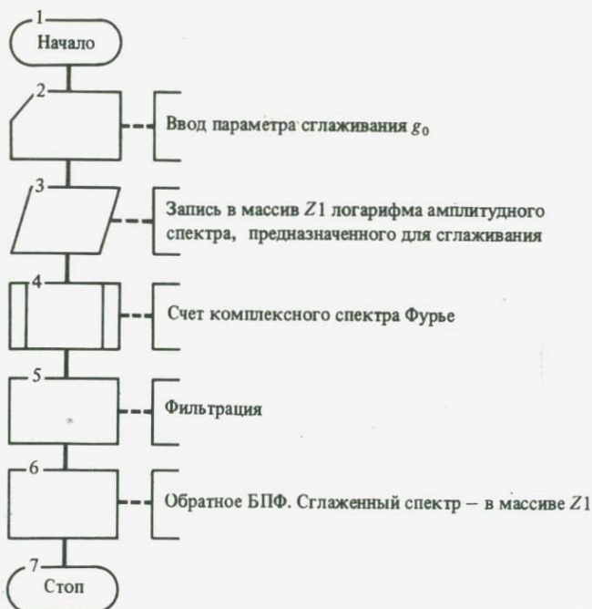
Рис. 2. Блок-схема 2 алгоритма сглаживания
