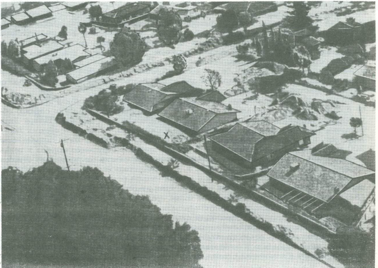
Рис. 18.4. Селевой поток, разрушивший жилой район в восточной части города Лос-Анджелес. В пункте, отмеченном X в центре фотографии, было отложено около 2 м (6 футов) ила, песка и гравия. Ко времени фотографирования расчистка улиц уже завершена (фото Геологической службы США)
