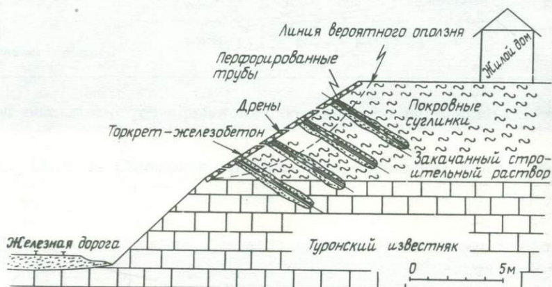
Рис. 15.10. Укрепление грунта на оползневом участке в процессе ведения работ на Бриалейской трассе
