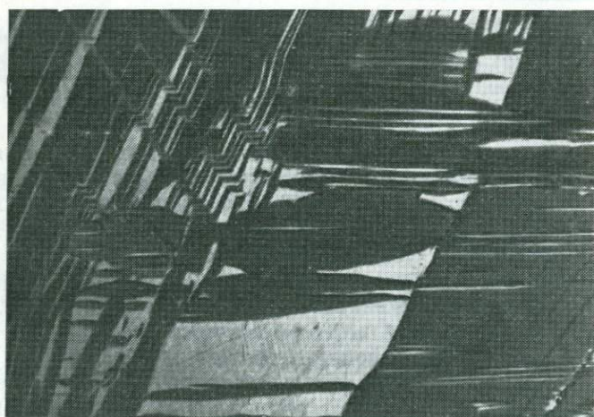
Р и с. 97. Пластинчатый высокотемпературный халькопирит, частично полисинтетически сдвойникованный. Бухвальд, Вальдбах, Австрия [500]. Ув. 90.
