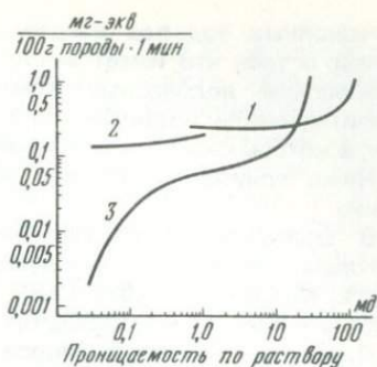
Рис. 35. Взаимосвязь миграции веществ и проницаемости по газу 1 — MgCO_3 в водах ClNa и SO_4ClNa состава; 2 — CaSO_4 в водах ClNa состава; 3 — CaCO_3 в водах ClNa и SO_4ClNa состава
