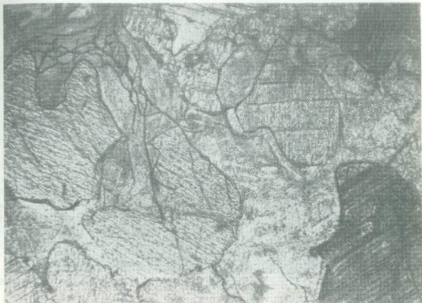
Рис. 23. Пренитизированное оливиновое габбро со станции К-432, обр. К-432-ДЗ-72-1, ув. 28, с анализатором
