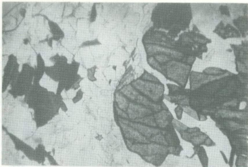
Рис. 50. Гранат-кордиерит-ортоклазовый гранулит со станции 1449, обр. 1449/2, кв. 40, без анализатора
