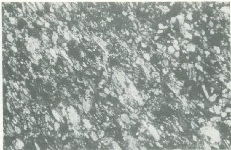
Рис. 16. Роговообманковый сланец из разлома Хейзен, обр. 2173/11, ув. 63, с анализатором
