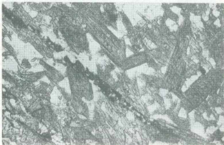
Рис. 12. Полосчатый амфиболит со станции 352, обр. 352/31, ув. 40, без анализатора
