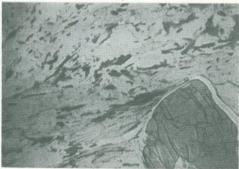
Рис. 37. Двуслюдяные сланцы с гранатом, станция 184, обр. 184/1, ув. 28, без анализатора
