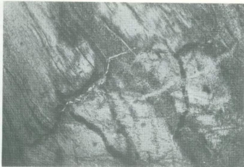
Рис. 25. Оталькованный баститовый серпентинит со станции К-441, обр. К-Д-4-6, ув. 28, с анализатором
