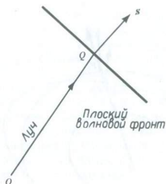
Рис. 5.17. Для плоского волнового фронта направление луча (определяемое потоком энергии) в общем случае не является перпендикулярным к волновому фронту и не обязательно лежит в сагиттальной плоскости.
