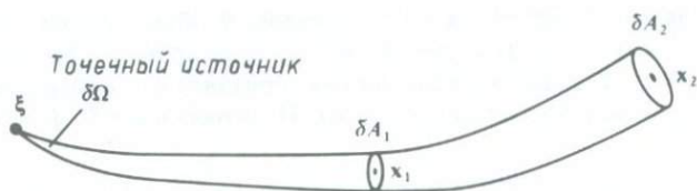
Рис. 5.3. Параметры лучевой трубки, исходящей из точечного источника в \xi . Сечения трубки в x_1 и x_2 равны \delta A_i = \delta\Omega \mathcal{R}^2(x_i, \xi) ( i = 1, 2 ), где \delta\Omega — телесный угол в источнике. Согласно геометролучевой теории, энергия, пересекающая \delta A_1 в единицу времени, та же, что энергия, пересекающая \delta A_2 в единицу времени (с учетом временной задержки на пробег между x_1 и x_2 ).
