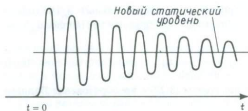
Рис. 8.3. Запись колебаний почвы в заданной нормальной моде, возбужденной источником в виде ступенчатой функции в момент t = 0 .
