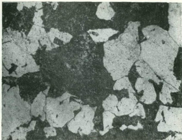
Фото 29. Аляскитовый (гиперсолъвус) гранит огнистого комплекса. Характерна интенсивная пелитизация калинатрового полевого шпата. Костинский массив, верхнее течение р. Костинной. Шлиф 1889, николи \parallel , увел. 38.
