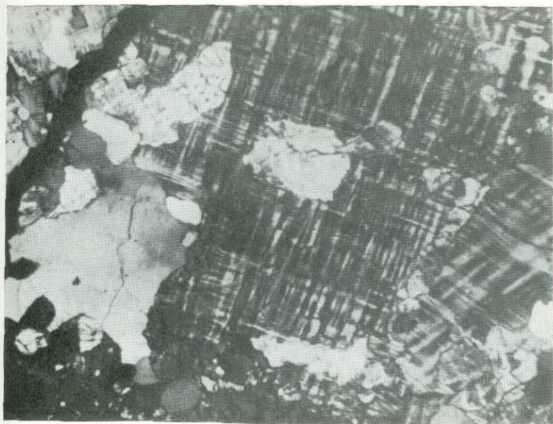
Фото 9. Порфиробласт микроклина в метасоматическом граните Посольненского мигматит-плутона. Р. Посольная, 100 м ниже устья Средней Горевой. Шлиф 1628, николи +, увел. 35.
