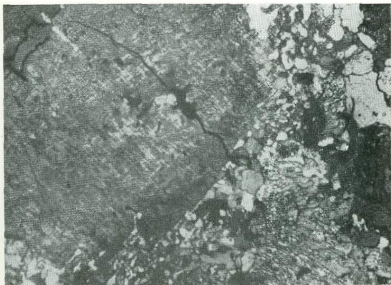
Фото 22. Гранофировая «рубашка» каликатрового полево шпате. Там же, 6 км ниже устья р. Полой. Шлиф 1519-3, николи+, увел. 38.
