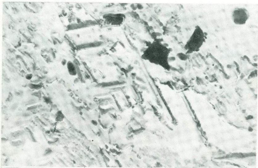
Рис. 101. Развитие слоистого силиката по трещинам спайности ортоклаза из вкрапленников гранодиорита Якутии. Обр. 471а З. Г. Караевой. Ув. 54 000
