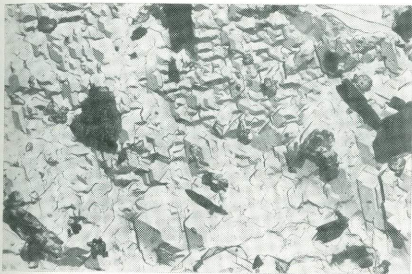
Рис. 24. Перекристаллизованный гнездовой криолит из полевошпатового метасоматита Восточной Сибири. Обр. К-1 С. В. Рябенко. Ув. 5000
