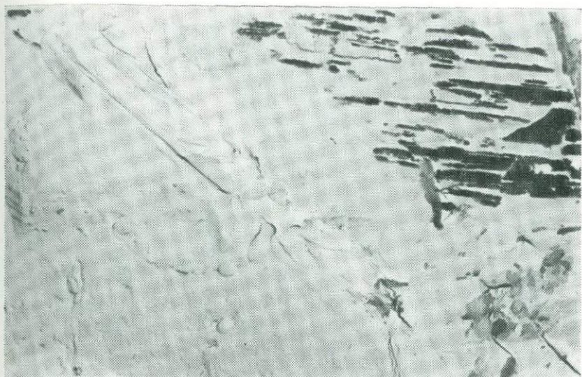
Рис. 114. Ориентированные вроски рорита в цирконе из карбонатов Восточной Сибири. Обр. 2153а В. С. Гайдуковой. Ув. 13 000
