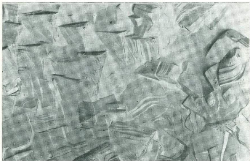
Рис. 212. Агрегат кристаллов пирохлора и лопарита после прокаливания исходного кристаллического пирохлора до 1200^{\circ}\text{C} в течение 2 ч. Обр. 2100. Ув. 5000
