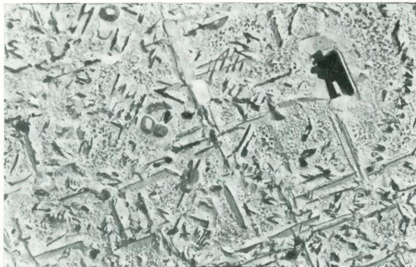
Рис. 123. Структура распада твердого раствора в магнетите из апатит-форстерит-магнетитовой породы Ковдорского массива. Крупные пластинчатые выделения ульвешпинели, переходящие при окислении в ильменит. Крупное зерно — герцинит (распад II). Тонкие ламели внутри квадратов — магнетит (распад III). Обр. 62-3/5 Е. М. Эпштейна. Ув. 5000
