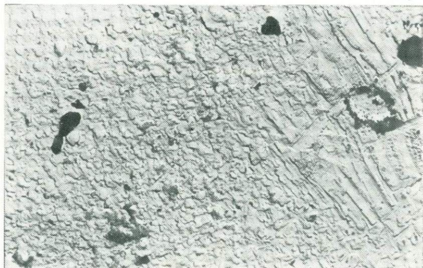
Рис. 207. Магнетит, нагретый до 800 °С в инертной среде. Ув. 5000
