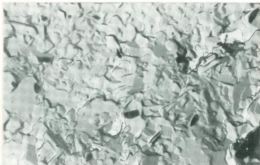
Рис. 218. Пластинчатые кристаллы самарезита и октаэдрические кристаллы пирохлора в метамиктном уранпирохлоре, прокаленном до 1000 °С в течение 1 ч. Обр. 4504д. Ув. 10 000
