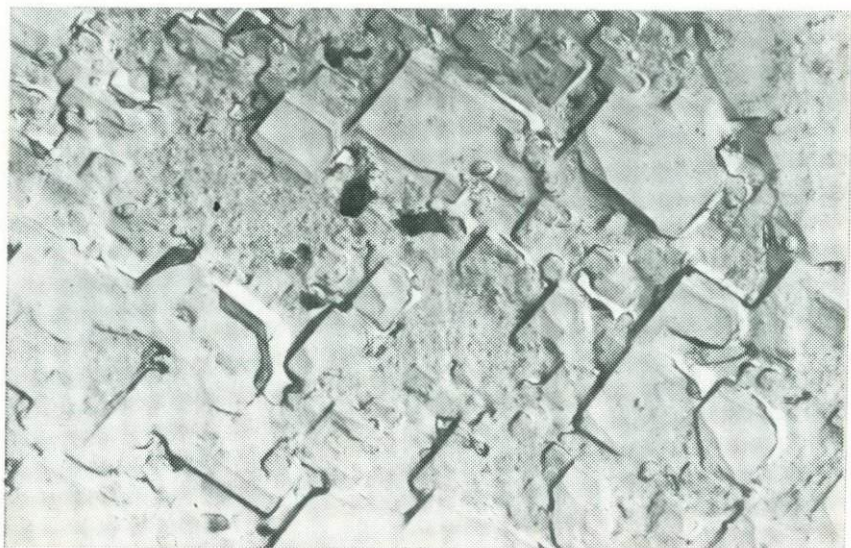
Рис. 201. Лабрадор, протравленный в парах плавиковой кислоты в течение 1 мин. Ув. 15 000
