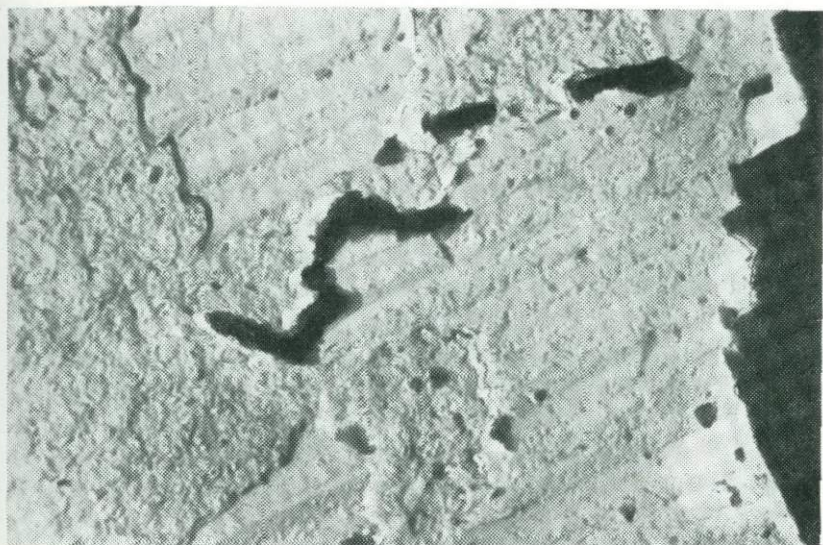
Рис. 76. Реликтовая полосчатая микроструктура среди колломорфной массы в метамиктном пирохлоре из редкометальных метасоматитов Восточной Сибири. Обр. 69 Т. Н. Шуриги. Ув. 10 000
