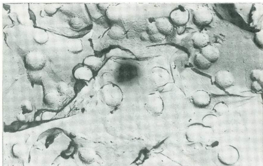
Рис. 10. Микроблочное строение кварца из близповерхностных грейзенов Якутии. Глобулы — аморфный кремнезем. Обр. 662л З. Г. Караевой. Ув. 5000
