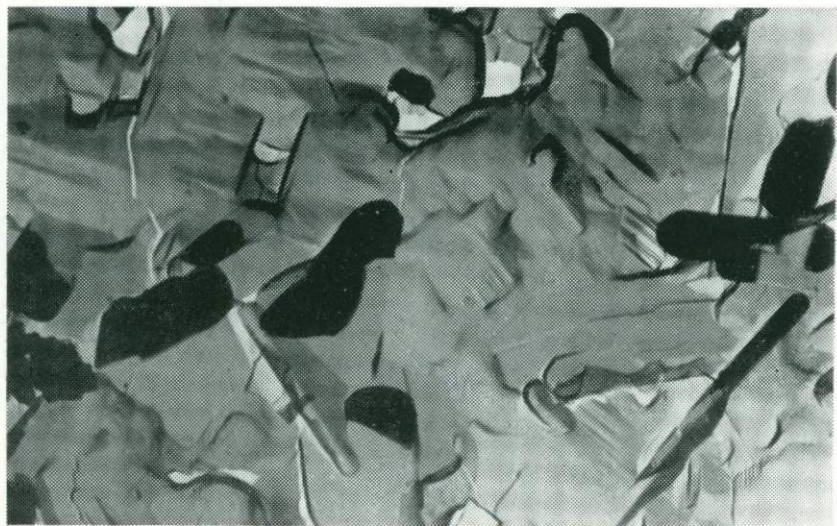
Рис. 211. Пластинчатые выделения лущита и рекристаллизованный пирохлор, образованные после прокаливания кристаллического пирохлора до 1000 °С в течение 1 ч. Обр. 3301. Ув. 13 000
