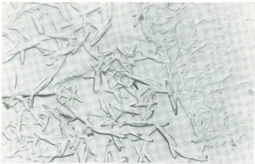
Рис. 198. Игольчатые кристаллы малладрита на поверхности альбита, протравленного в объеме концентрированной плавиковой кислоты в течение 1 мин. Ув. 15 000
