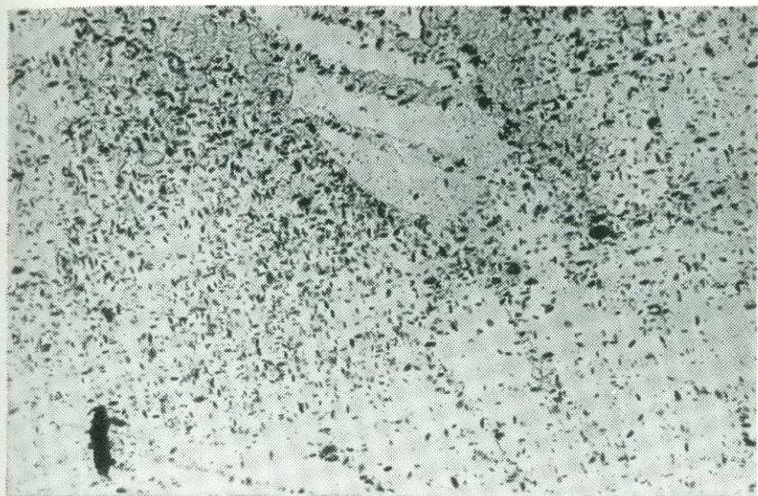
Рис. 131. Закономерное расположение иголок рутила в касситерите из пегматитов Калбы (Алтай). Обр. 1 Л. Б. Ворониной. Ув. 30 000
