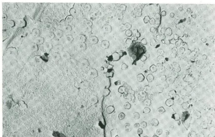
Рис. 79. Кристаллиты пирохлора, образовавшиеся в результате раскристаллизации метамиктного вещества. Вкрапленный пирохлор из метасоматитов Восточной Сибири. Обр. 21/183 Т. Н. Шурги. Ув. 7500
