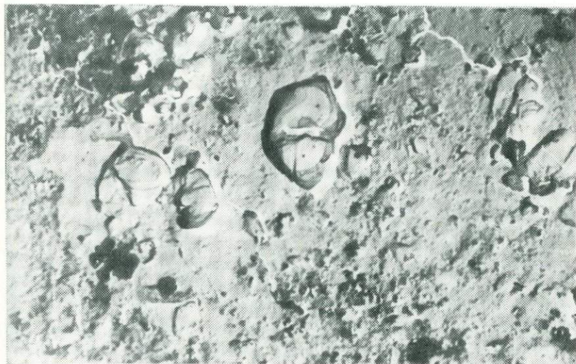
Рис. 184. Отдельные чешуйчатые зерна синтезированного молибденита в тонкозернистой массе. Обр. И. М. Воробьева, опыт 528. Ув. 3000
