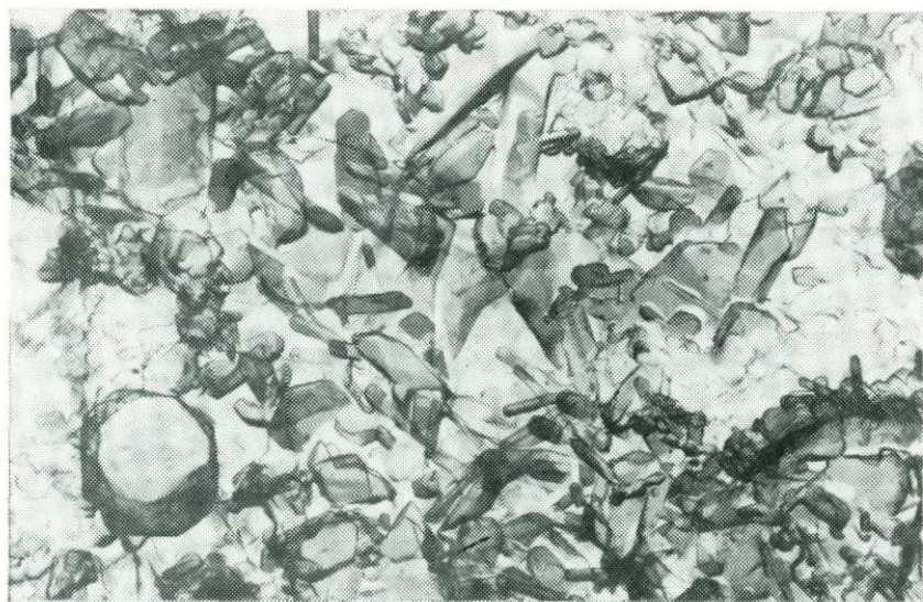
Рис. 199. Калий-натриевый полевой шпат, протравленный в объеме концентрированной плавиковой кислоты в течение 1 мин. Видны игольчатые кристаллы малладрита и кубические кристаллы гьератита. Ув. 15 000
