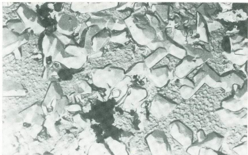
Рис. 63. Хорошо ограниченные кристаллики браннерита, погруженного в тонкодисперсную массу того же минерала. Пирит-карбонат-калишпатовые метасоматиты. Обр. В. М. Поляковой. Ув. 5000
