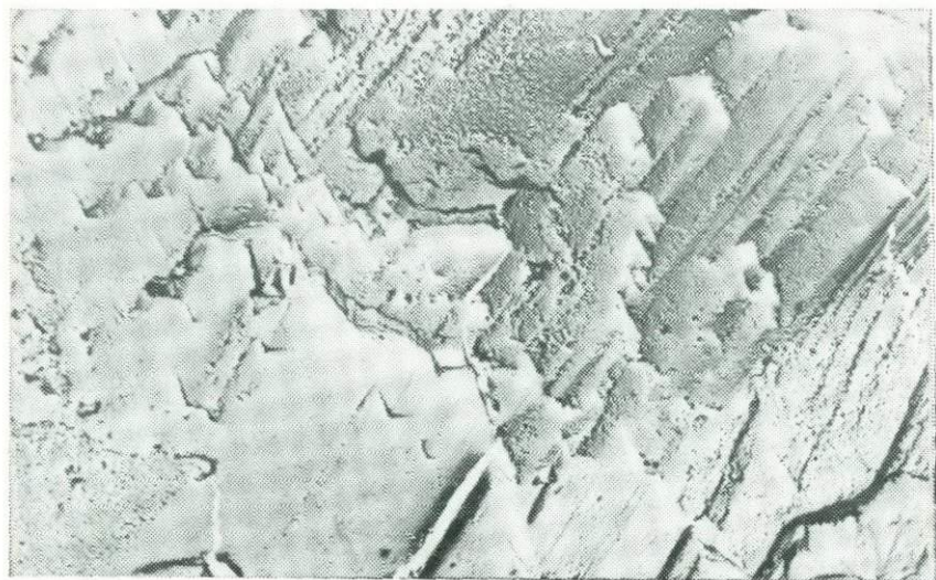
Рис. 91. Сильно корродированная грань кристалла пирохлора из карбонатитов Восточного Саяна. Обр. 4814 В. С. Гайдуковой. Ув. 3000
