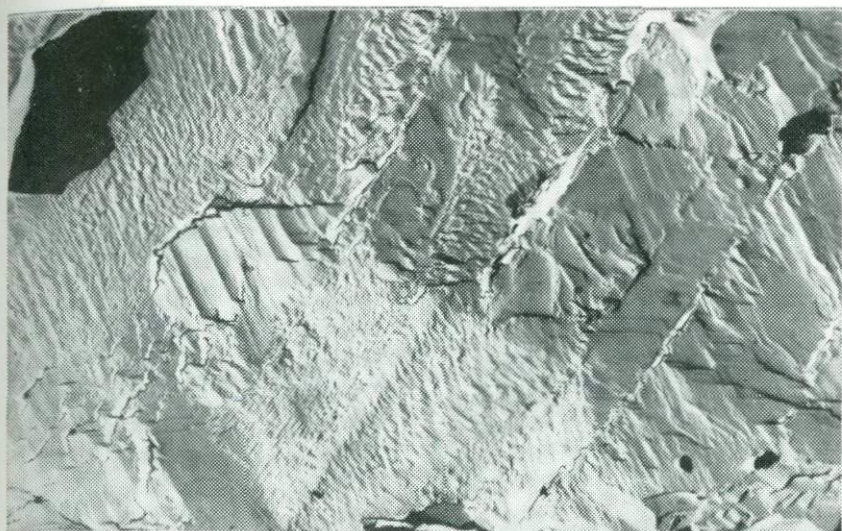
Рис. 51. Деформированный и перекристаллизованный амазонит из прожилков альбитизированных гранодиоритов Забайкалья. Обр. 69/3 З. К. Каравой. Ув. 5000
