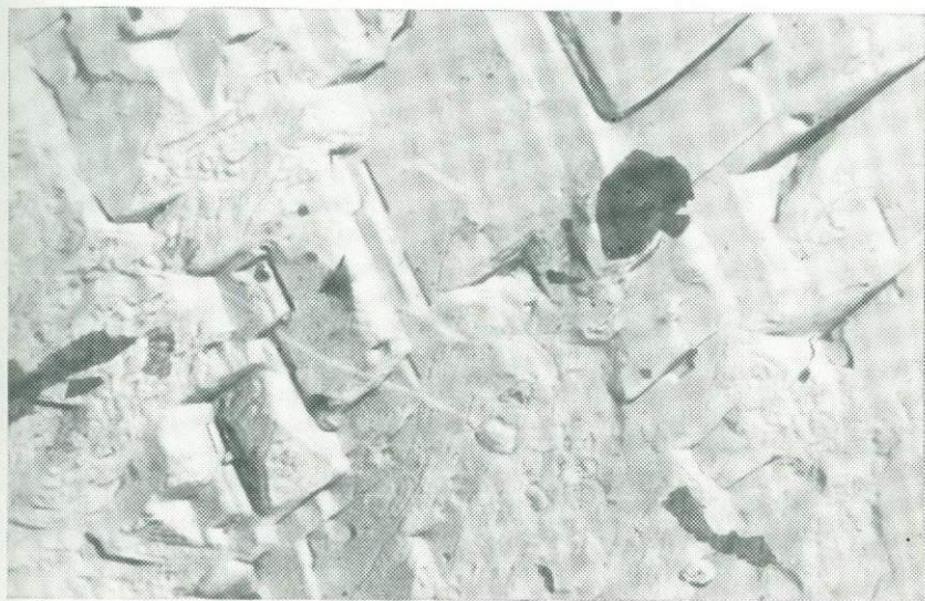
Рис. 23. Блочное микростроение оловосодержащего граната из скарнов Северо-Запада европейской части СССР. Обр. 0439 И. М. Григорьева. Ув. 30 000
