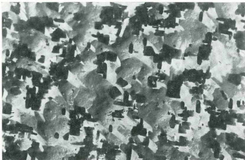
Рис. 133. Эпитаксическое нарастание пластинок тапиолита на касситерит. Близповерхностные грейзены Якутии. Обр. 360 Л. Б. Ворониной. Ув. 15 000
