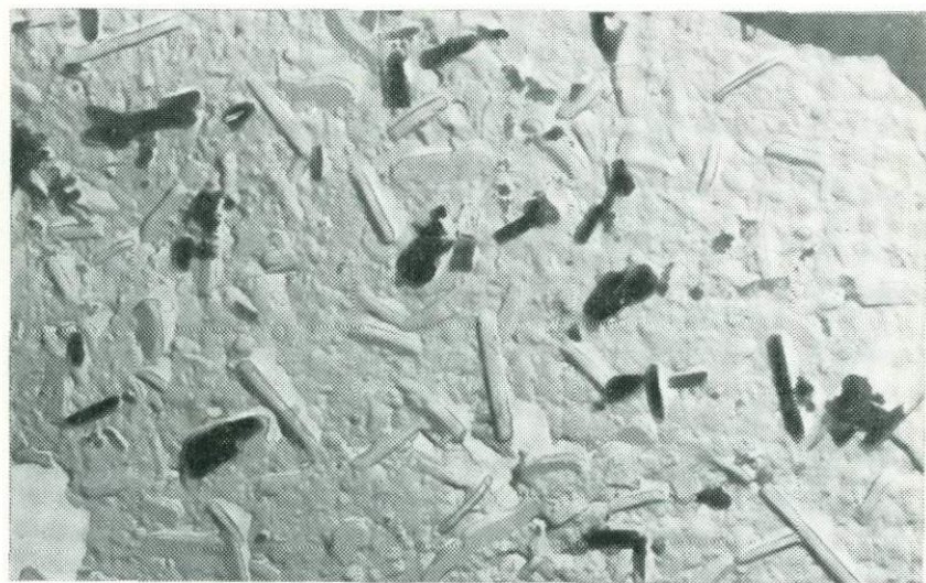
Рис. 219. Иголочки самарезита в метамиктном уранпирохлоре после нагревания до 1000 °С в течение 1 ч. Обр. 4504д. Ув. 5000
