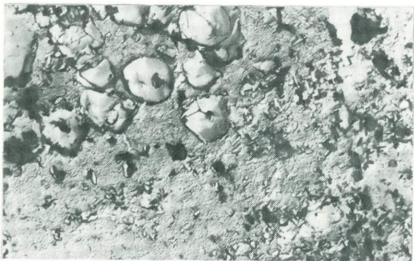
Рис. 179. Рекристаллизация метамиктного браннерита. Видны хорошо образованные кристаллы браннерита на фоне слабораскристаллизованной массы. Обр. К. Г. Королева. Ув. 2000
