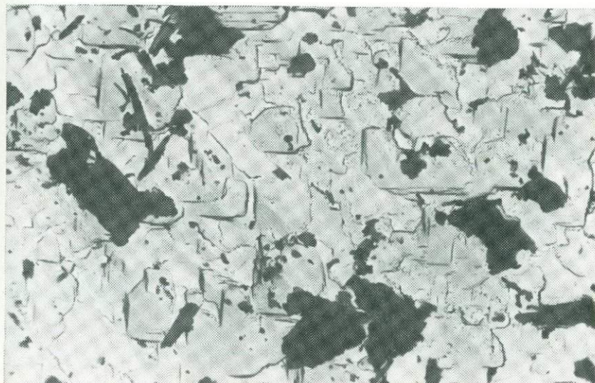
Рис. 20. Микроблочное строение циркона из карбонатов Восточного Саяна. Обр. 110-9 В. С. Гайдуковой. Ув. 3000
