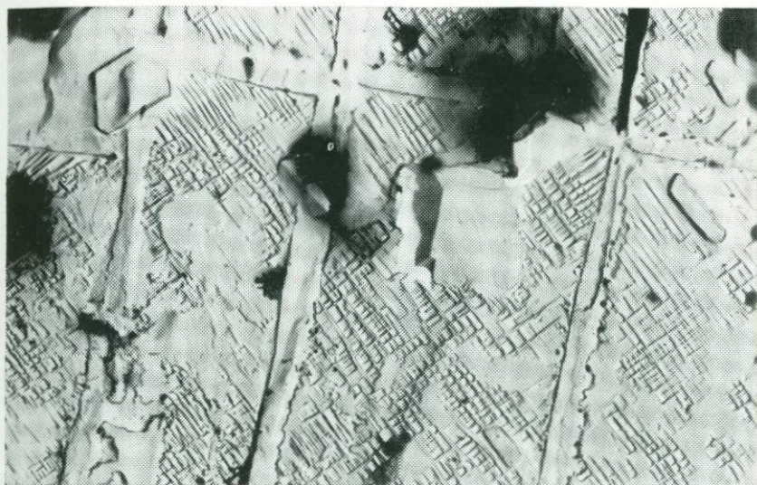
Рис. 118. Структуры распада твердого раствора в титаномагнетите из карбонатных пород Судана. Крупные и мелкие пластинки — ульвешпинель, изометричные зерна — шпинель. Обр. Г. П. Шахова. Ув. 3000
