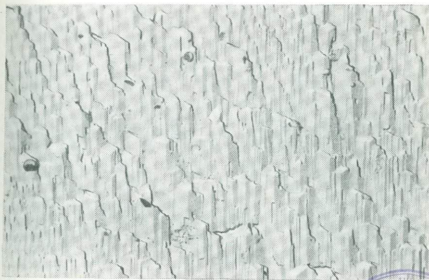
Рис. 6. Тонкостолбчатая микроструктура рудного ортоклаза из мелкозернистого гранита Северо-Востока СССР. Обр. 656д З. Г. Караевой. Ув. 30 000
