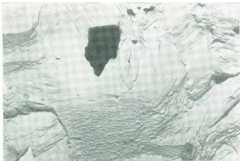
Рис. 18. Деформационная структура гнездового криолита из криолитовой зоны полевошпатовых метасоматитов Восточной Сибири. Обр. 24/79 С. В. Рябенко. Ув. 5000
