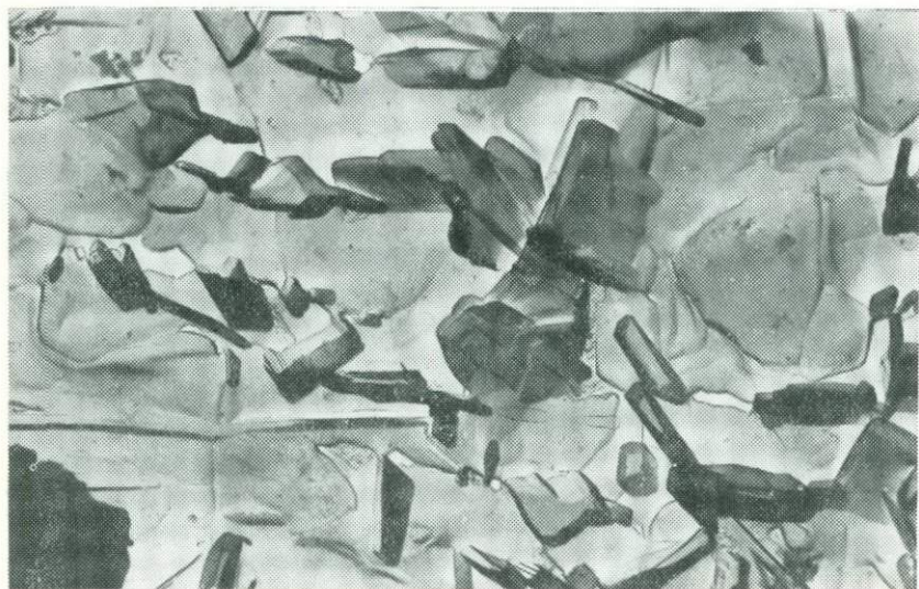
Рис. 214. Пластинчатые кристаллы ферсмита в кристаллическом пирохлоре, нагретом до 800 °С в течение 1 ч. Обр. 86-24. Ув. 10 000
