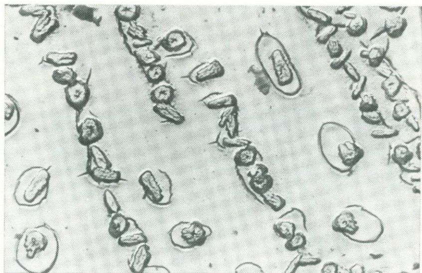
Рис. 203. Лабрадор, протравленный в парах плавиковой кислоты в течение 1 мин. Ув. 15 000
