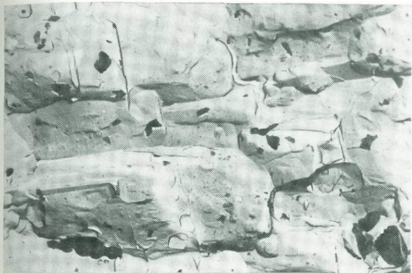
Рис. 49. Блочное микростроение берилла из мусковит-флюорит-бериллового месторождения. Восточная Сибирь. Обр. 2425 В. Т. Шацкой. Ув. 3000
