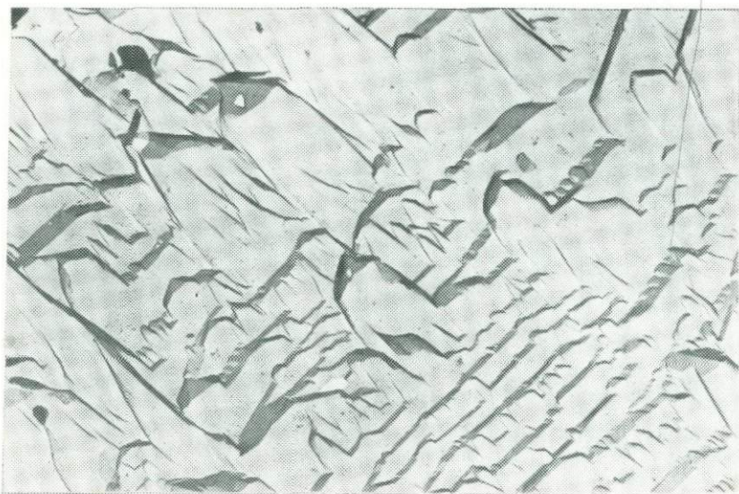
Рис. 36. Сложноступенчатый микрорельеф берилла из флогопит-маргарит-бериллового месторождения, Западная Сибирь. Обр. 34-152 И. И. Куприяновой. Ув. 7000
