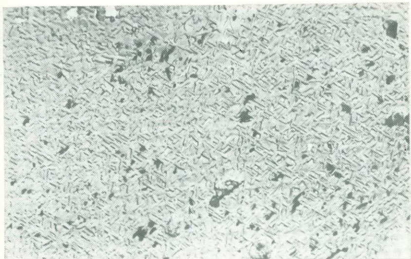
Рис. 208. Закономерно ориентированные иголки луешита в кристаллическом пирохлоре, прокаленном до 1000 °С в течение 1 ч. Обр. 4814. Ув. 5000
