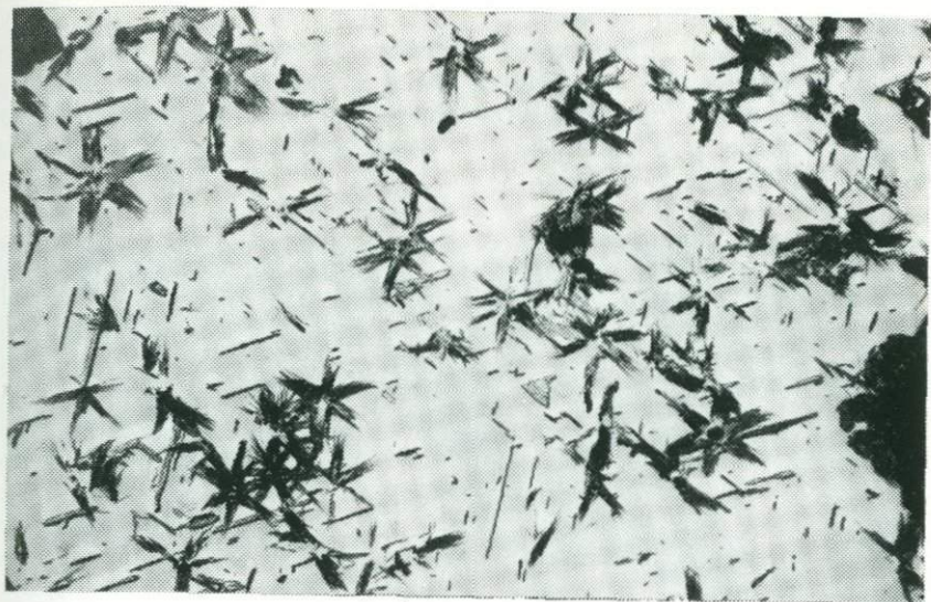
Рис. 121. Звездчатые структуры распада Ge -содержащего магнетита из гематитовой руды. Обр. 1 Г. С. Момджи. Ув. 7000
