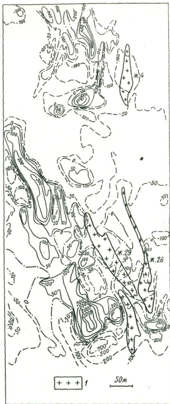
Рис.15. План изолиний \Delta Z , нТл, на месторождении пегматитов Слюдяной бор.
