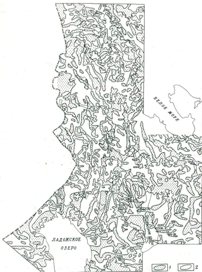
Рис. 56. Схема второй вертикальной производной силы тяжести. 1 - положительные аномалии; 2 - отрицательные аномалии.
