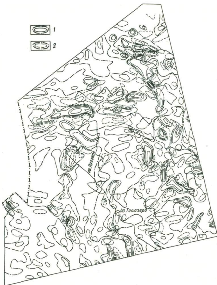
Рис. 25. Схема второй вертикальной производной поля силы тяжести Пяозерского блока и Тикшозерско-Хизоваарской мобильно-проницаемой зоны.
