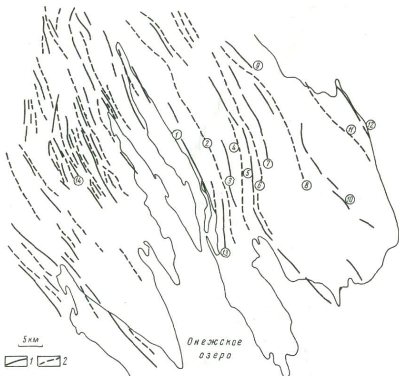
Рис. 46. Схема расположения осей магнитных аномалий Центрально-Онежского блока.
