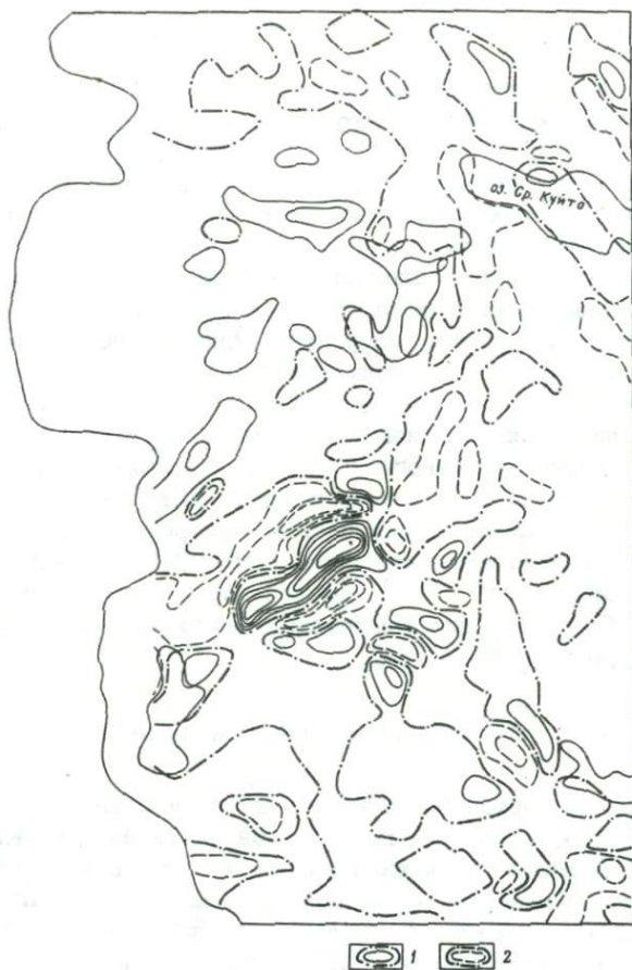
Рис. 28. Схема второй вертикальной производной поля силы тяжести Вокнаволоцкого блока.
