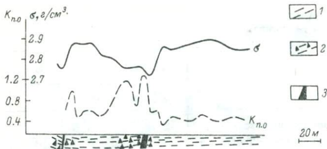
Рис. 5. Графики плотности и пористости пород на месторождении слюды Малиновая варака.
