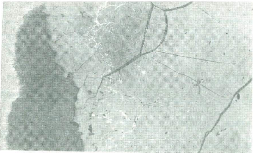
Рис. 1. Аншлиф 24. Клаусталит (белый) развивается по трещинкам и заполняет поры во внешней зоне почковидной корочки настурана. Микрофото, увел. 150
