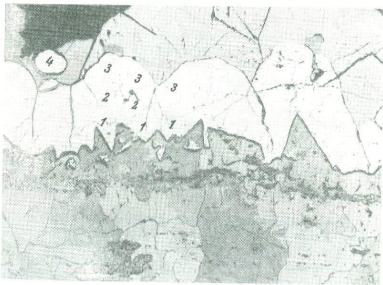
Рис. 2. Аншлиф 24. Кругами показаны места выбуривания проб 1-4, цифры отвечают порядковому номеру пробы. Микрофото, увел. 6
