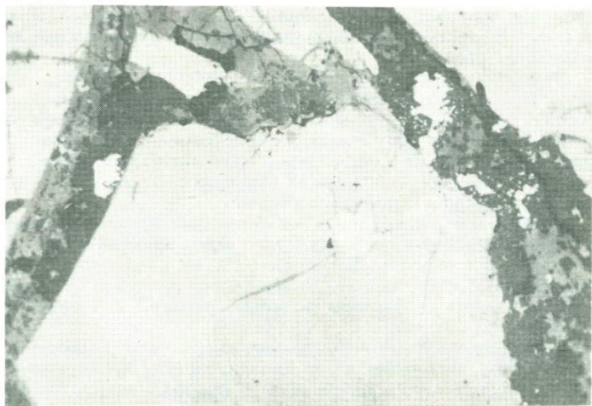
Рис. 7. Аншлиф 36. Развитие коффинита (К) по трещинкам в настуране. Микрофото, увел. 150
