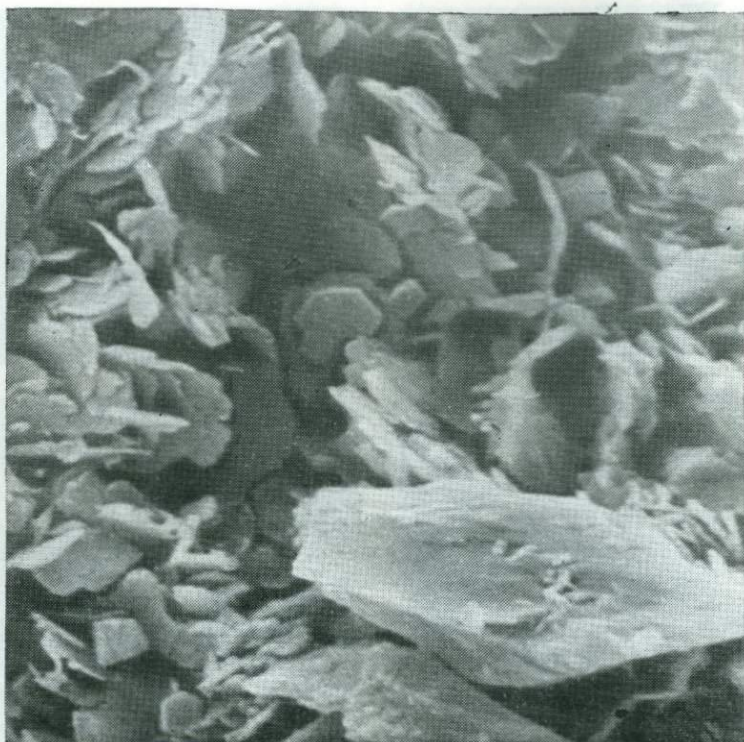
Рис. 37. Электронная микрофотография Fe-шамозита, \times 3000 Северо-восточная часть Енисейского края, р. Тея, у пос. Тея, вандадынская свита, песчаник голубовато-серый кварцевый разнозернистый
