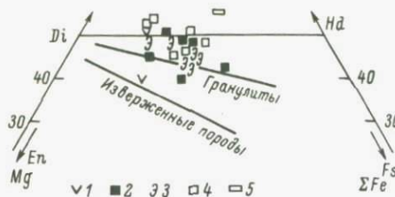
Рис.29. Диаграмма Ca-Mg-Fe для моноклинных пироксенов с магматическим и метаморфическим трендами по Биннсу (Binns, 1965).
