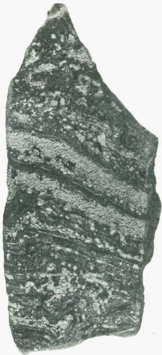
Рис. 18. Перекристаллизованная серно-колчеданная руда с полосчато-плойчатой текстурой
