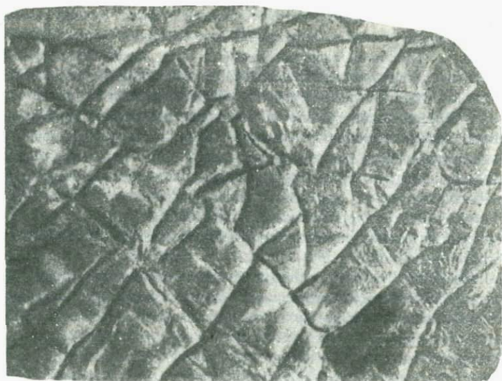
Рис. 30. Трещины усыхания в гематитовой руде Месторождение Калгута, по А.С. Калугину (1970)
