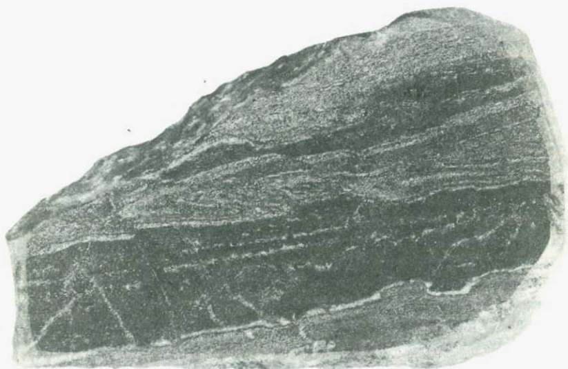
Рис. 15. Серно-колчеданная руда линзовидно-груболосчатой текстуры. Внутри прослоев видны отдельные микрослойки Полиров. штуф 111/1; умен. 1,2
