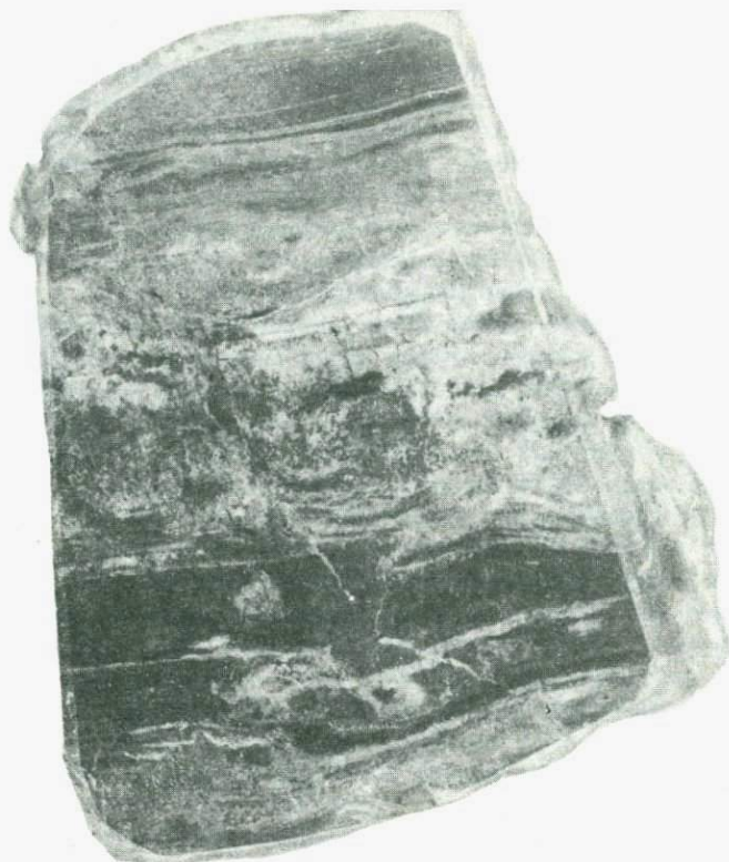
Рис. 4. Кремнистые туффиты с прослоями магнетитовых руд В прослое руд (в центре) виден обломок дацитовых порфиров гравелитовой размерности; полиров. штуп 503/2; натур. вел.
