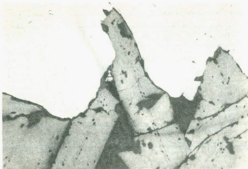
Рис. 21. Замещение мушкетовита (светло-серое) пиритом (белое) Полиров. шлиф 430/1; увел. 300
