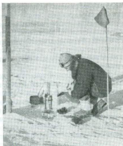
Рис. 60. Портативный гравиметр для измерения силы тяжести (Антарктида). Прибор перевозят в противоударной и термоизолированной алюминиевой цилиндрической коробке, которая видна на фотографии
