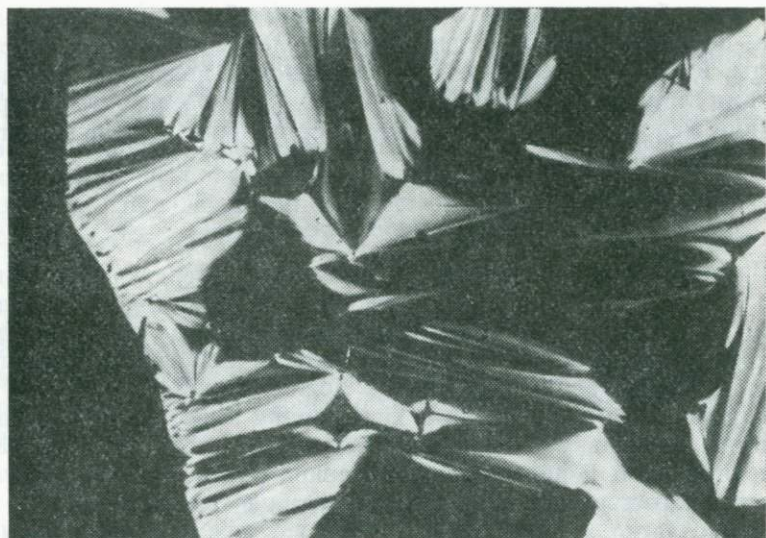
Рис. 4.5. Простая веерная текстура смектика А. Скращенные николи, \times 120 .
