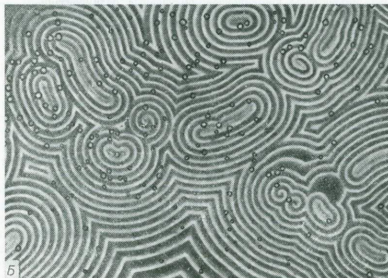
Рис. 6.4. Распространение фронта химической реакции в жидкости при комнатной температуре. Реагент Заикина и Жаботинского, модифицированный Уинфри (Winfree, 1973). Волны соответствуют окислительно-восстановительным потенциалам ионов металла, присутствующих в концентрациях, сравнимых с концентрациями катализаторов. Ион металла (или ионный комплекс) катализирует окислительное декарбоксилирование алифатической кислоты броматом в кислом водном растворе,
