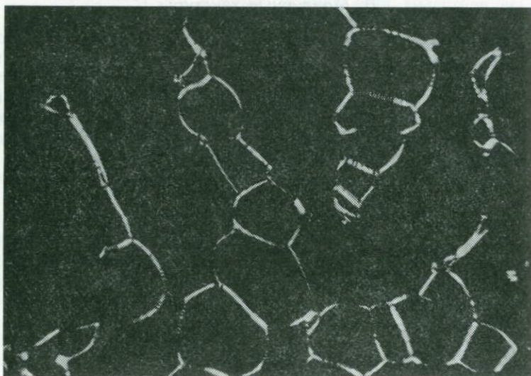
Рис. 4.8. Псевдоизотропная текстура с маслянистыми бороздками, ламеллярная фаза. Скращенные николи; лецитин (растительный) и вода. (Saure, 1977).
