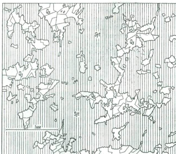
Рис. 48. Взаимоотношение сфалерита ( Sft ) и кварца третьей генерации ( Q_3 ) в рудном прожилке.
