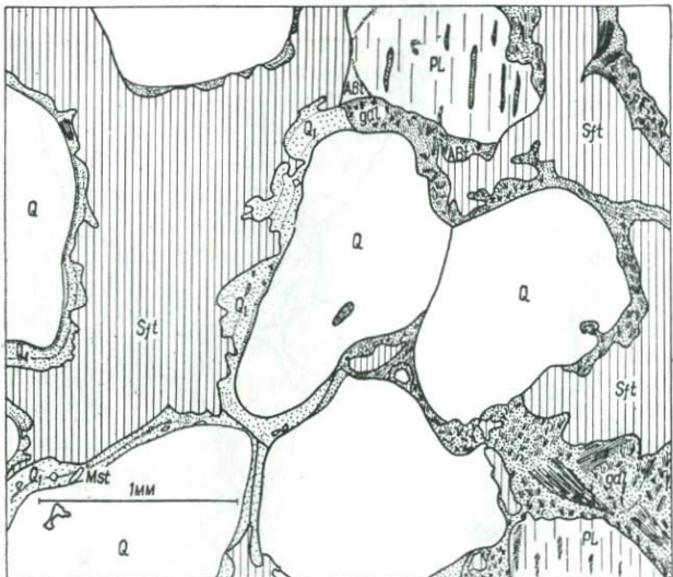
Рис. 43. Песчаник полевошпато (PL)-кварцевый, цемент регенерационно-поровый с элементами базального. Сфалерит ( Sft ) развивается после каолинита и гидрослюды ( gdl ) и отчетливо корродирует регенерационный кварц ( Q_1 ). В ассоциации с регенерационным кварцем — мусковит ( Mst ) и альбит ( Abt ).
