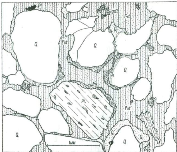
Рис. 44. Песчаник полевошпато-кварцевый, цемент регенерационно-поровый, базальтный. Кальцит ( Ka ) выделяется после регенерационного кварца ( Q_1 ), а флюорит ( Fr ) — после кальцита. Видны реликты глинисто-гидрослюдистого ( gdl ) цемента.
