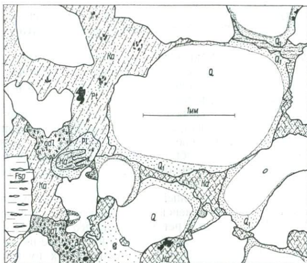
Рис. 39. Песчаник полевошпато-кварцевый. Цемент поровый, базальный и регенерационный. Минералы стадии диagenеза представлены криптоточешуйчатым каолинитом с примесью гидрослюд ( gdl ), кальцитом ( Ka ) и пиритом ( Pt ) — левая часть рисунка. В правой части — полнокристаллический кальцит корродирует регенерационный кварц ( Q_1 ).
